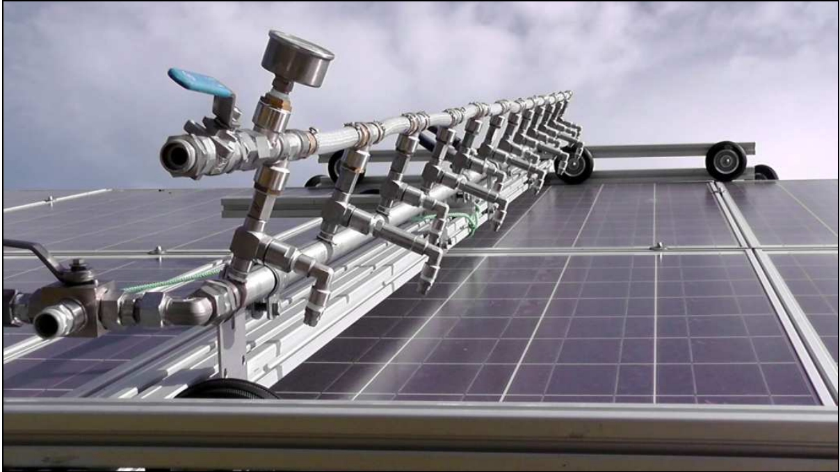
Abb. 4: Berührungsloses System TSC 2 (Foto: CleanUp-Solar)
