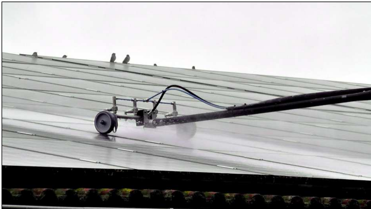
Abb. 3: Berührungsloses System TSC 1 (Foto: CleanUp-Solar)
