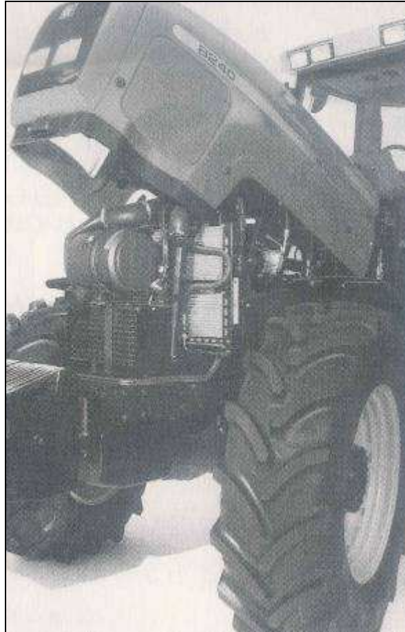
Abb.37: Gute Zugänglichkeit durch klappbare Motorhaube beim MF 6200/8200 der Firma Massey Ferguson
