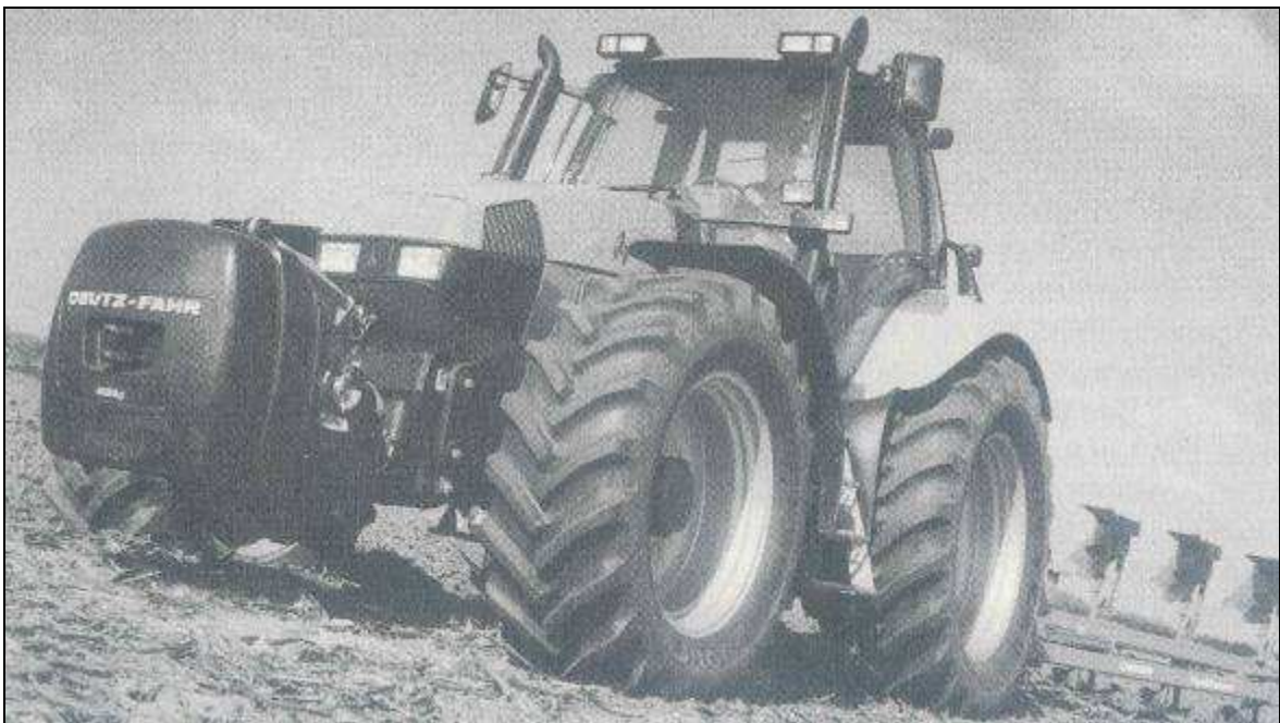
Abb. 24: Deutz-Fahr Agrotion 160-200 mit Motor-Getriebesteuerung und interessanter Frontballastierung
