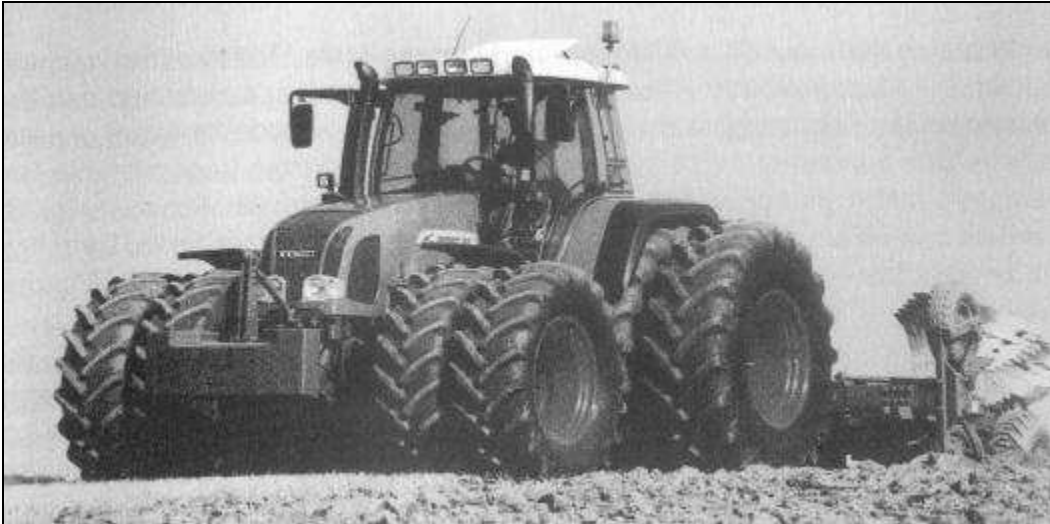
Abb 1: Fendt Vari 900 mit elektronischer Motorregelung, stufenlosem Getriebe und neuem Design
