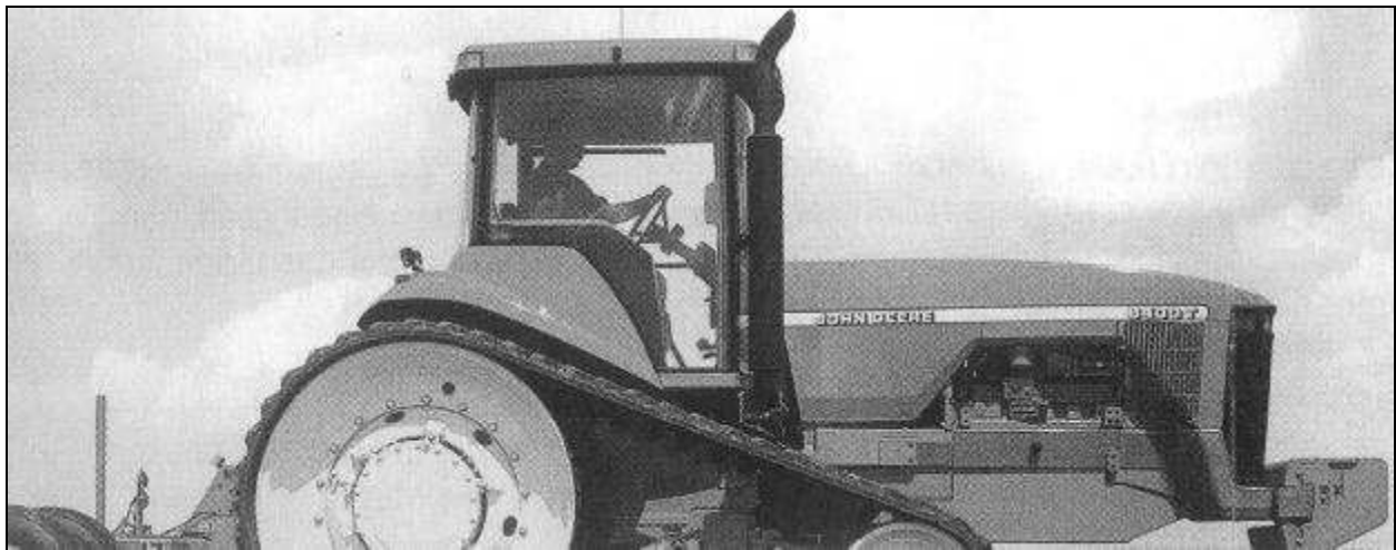
Abb. 11: Raupenfahrwerk als Alternative am John Deere 8400 T
