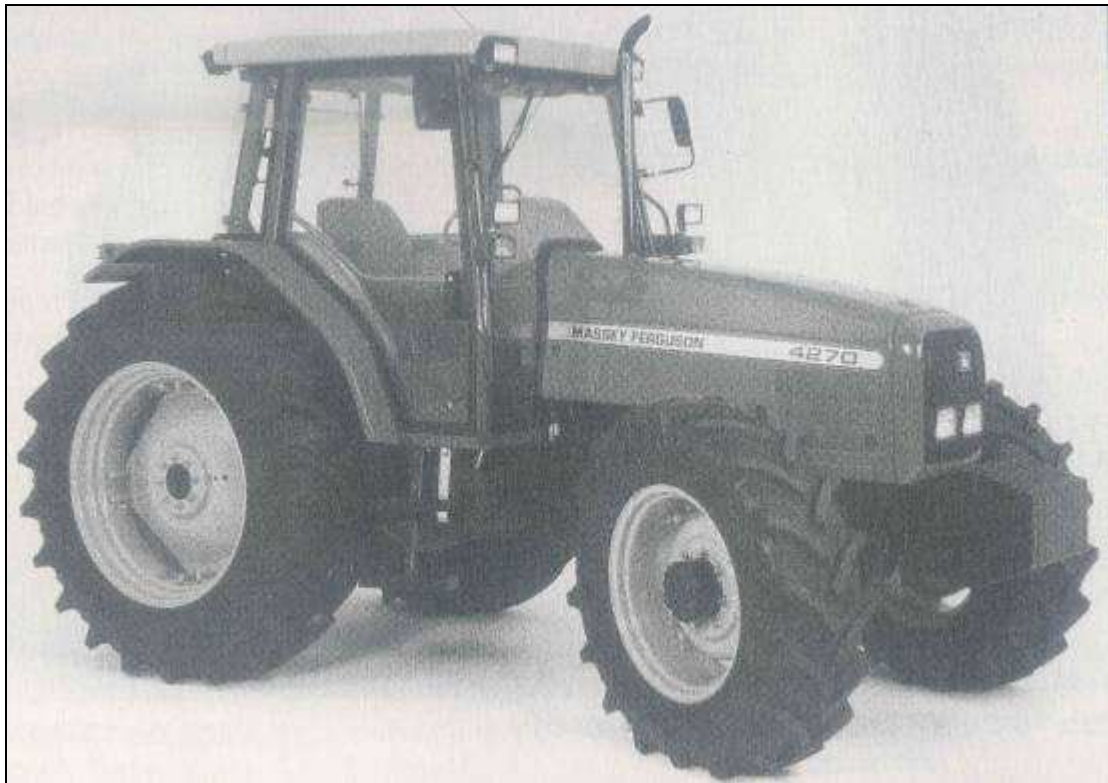
Abb. 15: Der MF 4270 der Firma Massey Ferguson mit dem 24/24 Powershuttle Wendegetriebe
