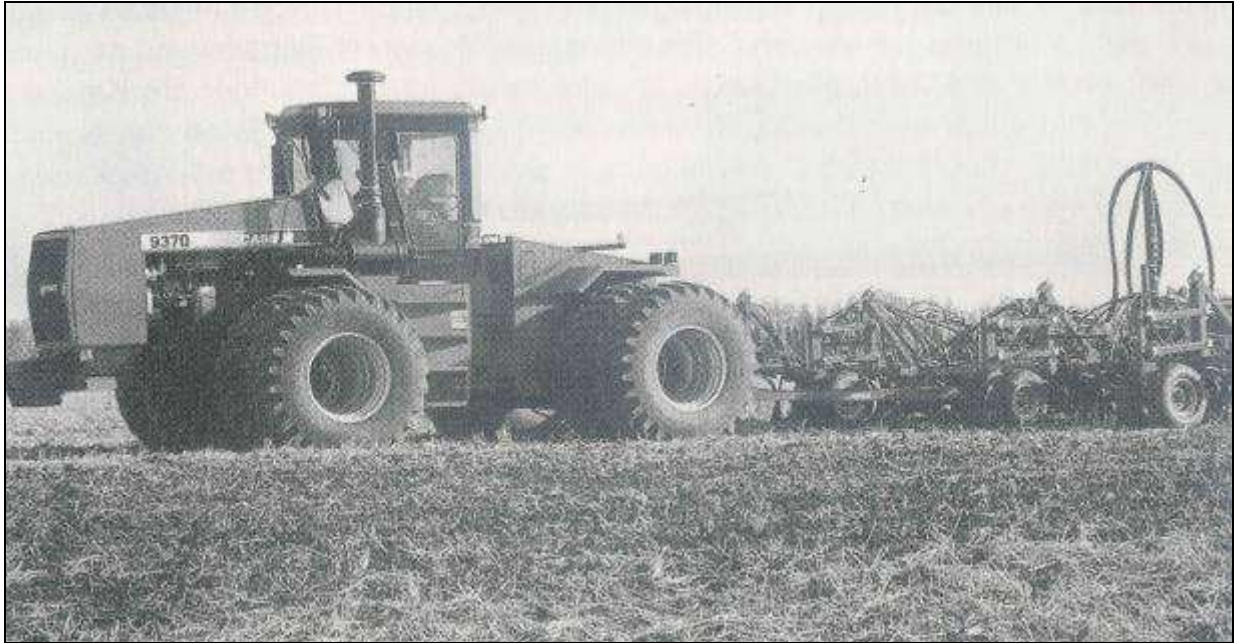
Abb. 7: Knicklenker Case ICH Steiger 9370 mit 265 kW Nennleistung
