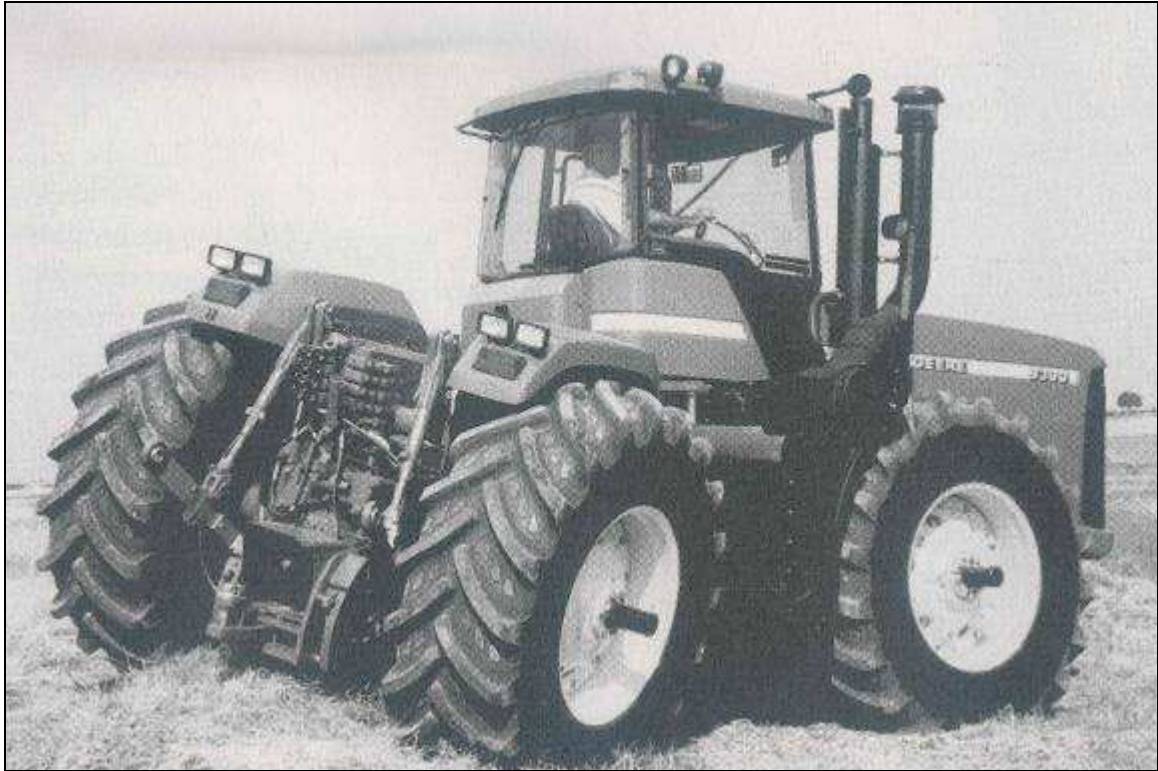
Abb. 9: John Deere Knicklenker 9300 mit 268 kW
