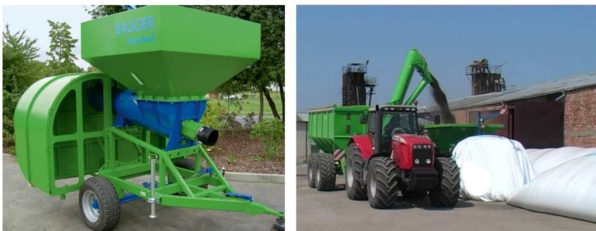
Abb. 5: Farm Bagger und Einlagerung von Getreide im Folienschlauch
