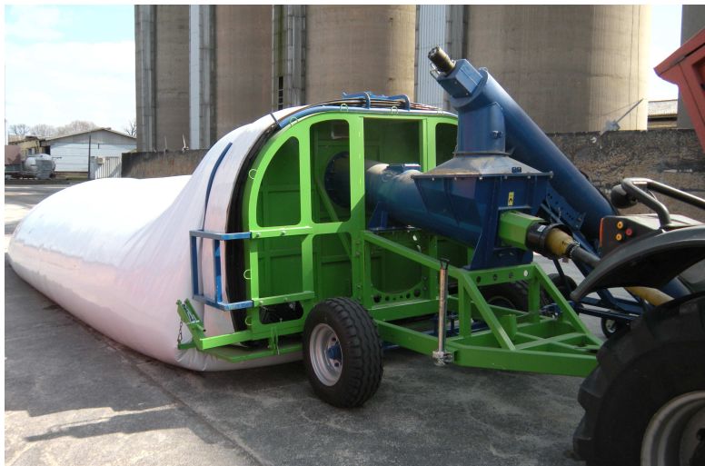
Abb. 13: Einlagerung von Getreide mit Farm Bagger und Befüllschnecke
