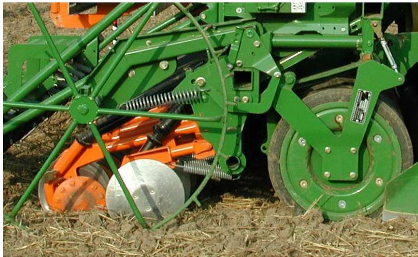
**Abb. 7:** RoTec- Rollschar und Vorwerkzeug Keilringwalze System Amazone
