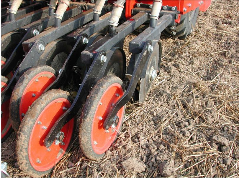
**Abb. 11:** Doppelscheibenschar mit nachlaufender Andruckrolle System Horsch
