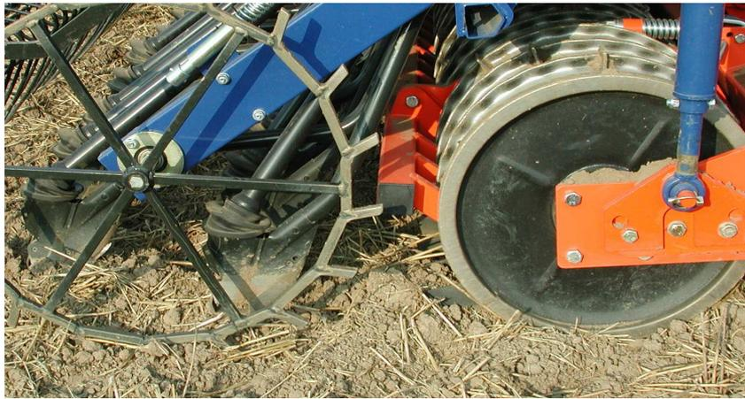
**Abb. 8:** Schleppschare und als Vorwerkzeug Packerwalze System Kongskilde
