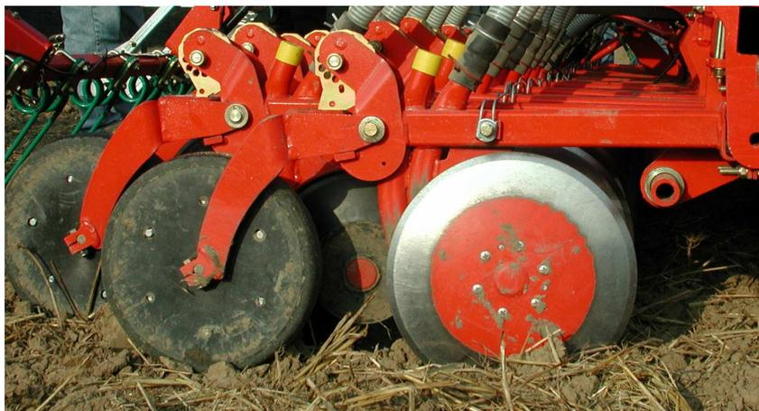
**Abb. 9:** CX-Scheibenschar mit nachlaufender Andruckrolle System Kverneland
