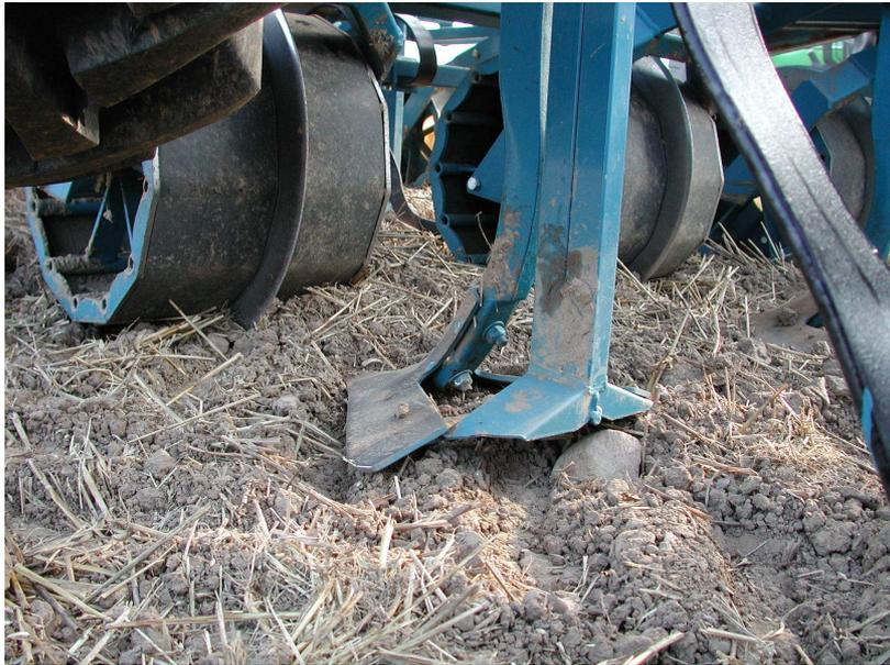
**Abb. 12:** Gänsefußschar mit Verteilerende System Köckerling
