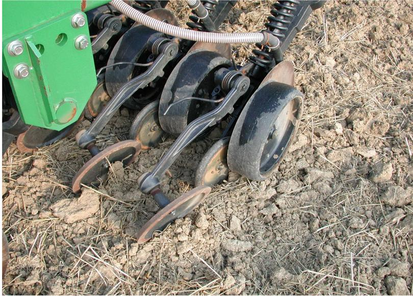
**Abb. 15:** Einscheiben-Säeinheit System John Deere
