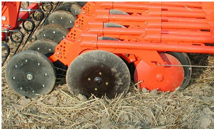
**Abb. 6:** RS-Scheibenschar mit nachlaufender Andruckrolle System Rauch
