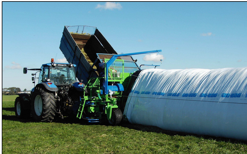
Bild 11: Das Einhalten des optimalen TM-Bereiches von 35-45% sichert eine aerobe Stabilität im Folienschlauch
