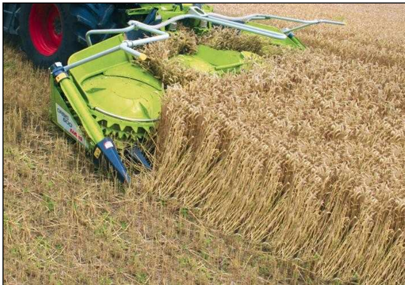
Bild 8: Reihenunabhängige Gebisse weisen für alle Erntebedingungen eine hohe Flexibilität auf.
