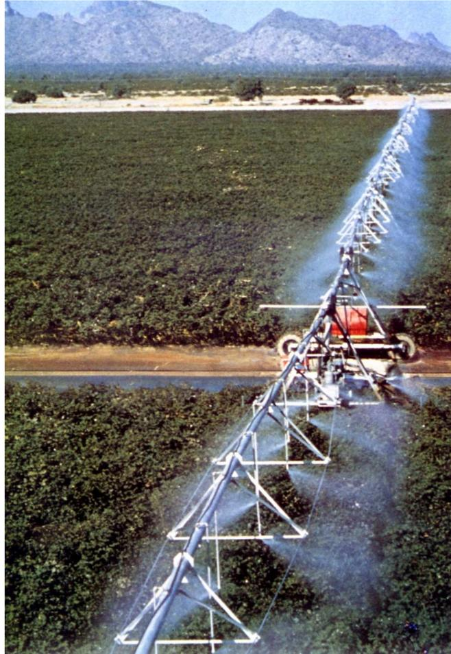
**Abb. 3-11:** Linearberegnungsmaschinen mit mittiger, offener Wasserzuführung, Baubreite 1000 m
