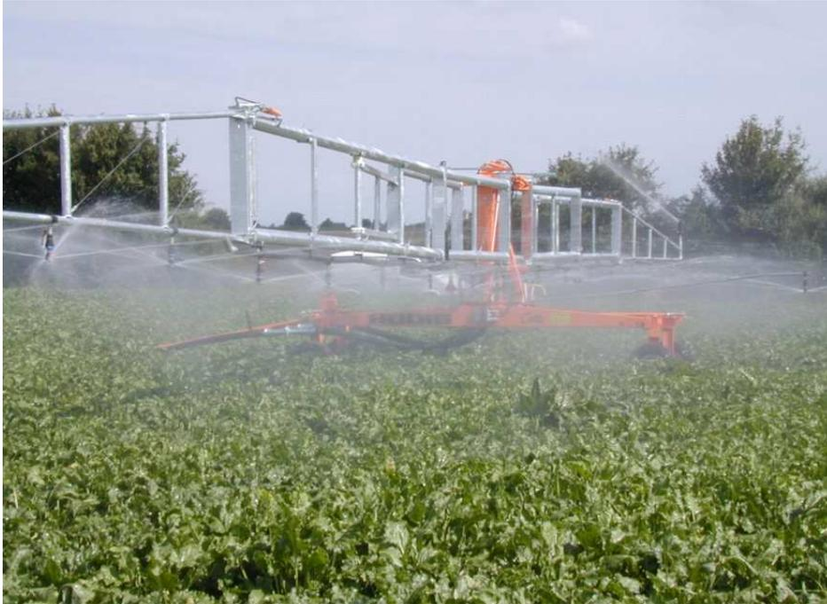
**Abb. 3-16:** Düsenwagen mit 72 m nutzbare Arbeitsbreite
