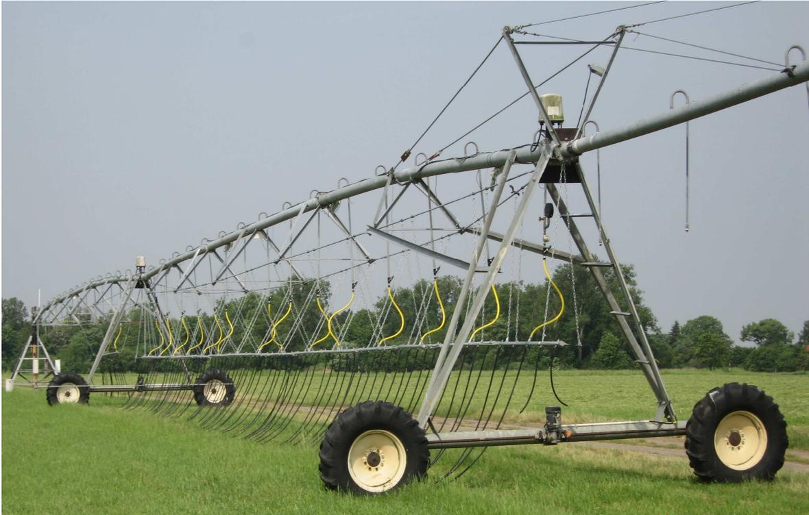
**Abb. 3-19:** Mobile Tropfbewässerung an einer Linearberegnungsmaschine im Versuchseinsatz
