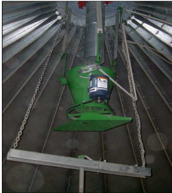
Abb. 6: Verteilschleuder mit Keilriemenantrieb und stufenlos regelbarem Motor. (Werkbild Geerdts)
