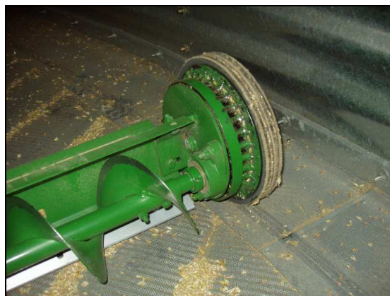
Abb.6: Antriebsrad einer Fegeschnecke mit Getriebeuntersetzung
