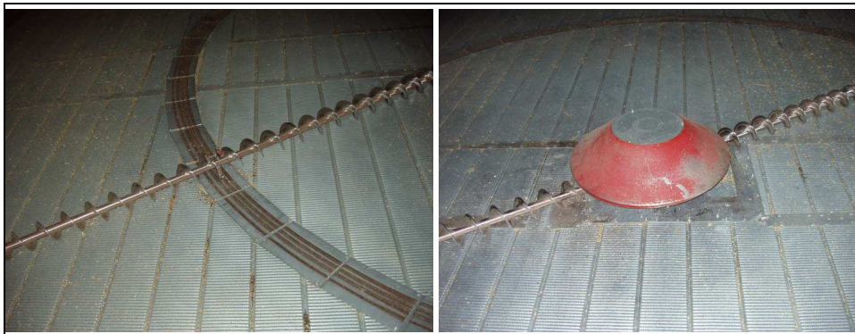
Abb. 22: Zweiarmlige Fegeschnecke im Silo-Durchlauftrockner Links= einseitiger Fegearm ohne Räumschild Rechts= Schutzglocke über dem mittigen Einlauf in die Entnahmeschnecke
