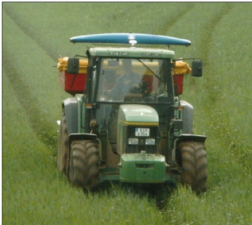
**Abb. 4:** YARA N-Sensor auf dem Schlepper dach (Foto: ILV Uni-Kiel)
