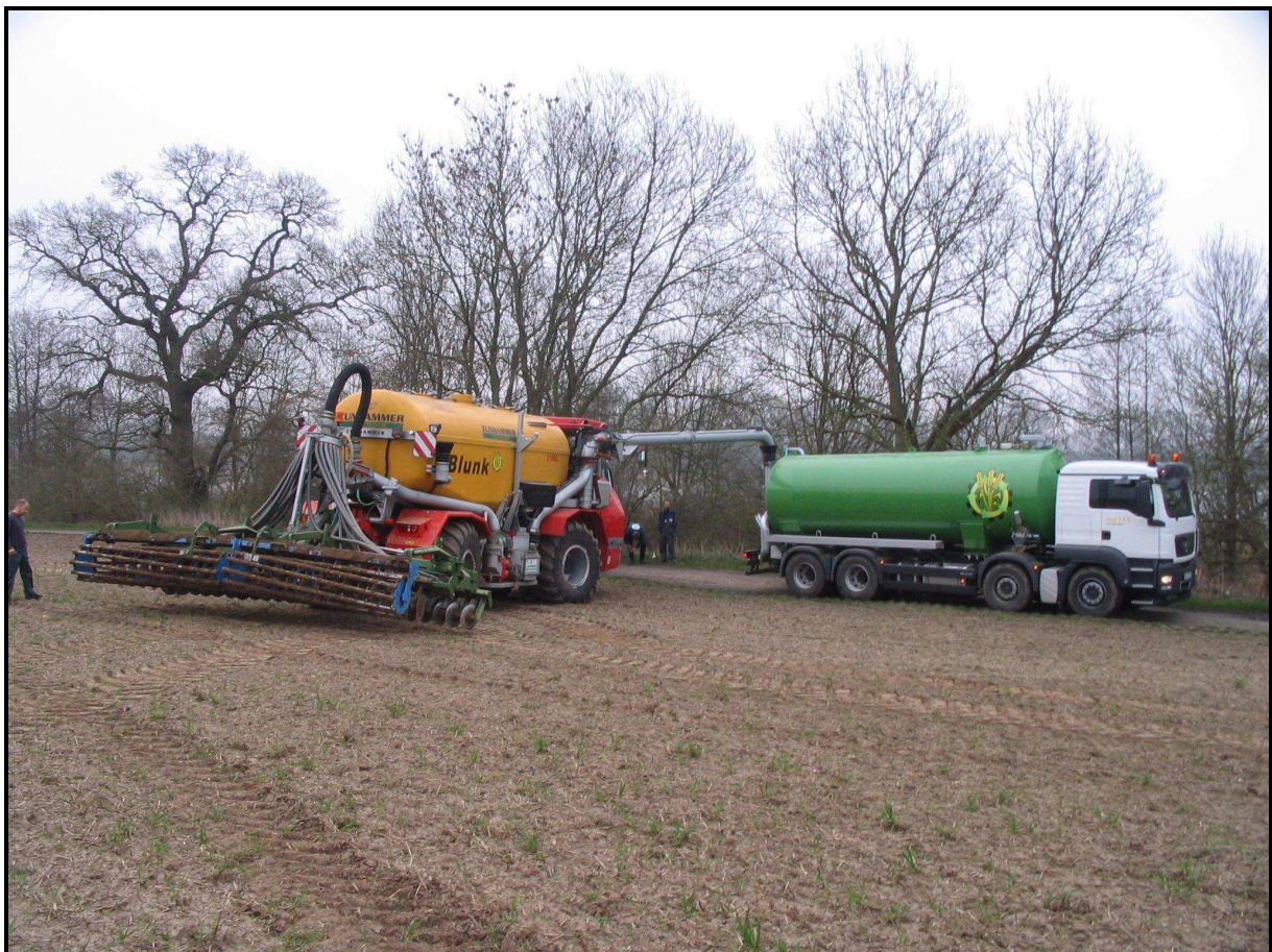
Abbildung 2: Zweiphasige Ausbringung mittels LKW-Transport auf der Straße und Niederdruck-Reifen Ausbringung auf dem Feld
