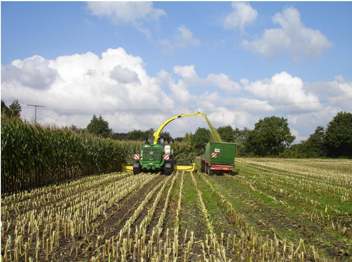
**Abbildung 3:** Feldhäcksler mit NIRS-Sensor zur TS- und Inhaltsstoff Bestimmung im Auswurfkrümmer
