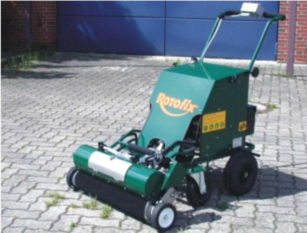
**Abb. 6:** Rotofix-System zur chemischen Beikrautregulierung auf Hofplätzen
