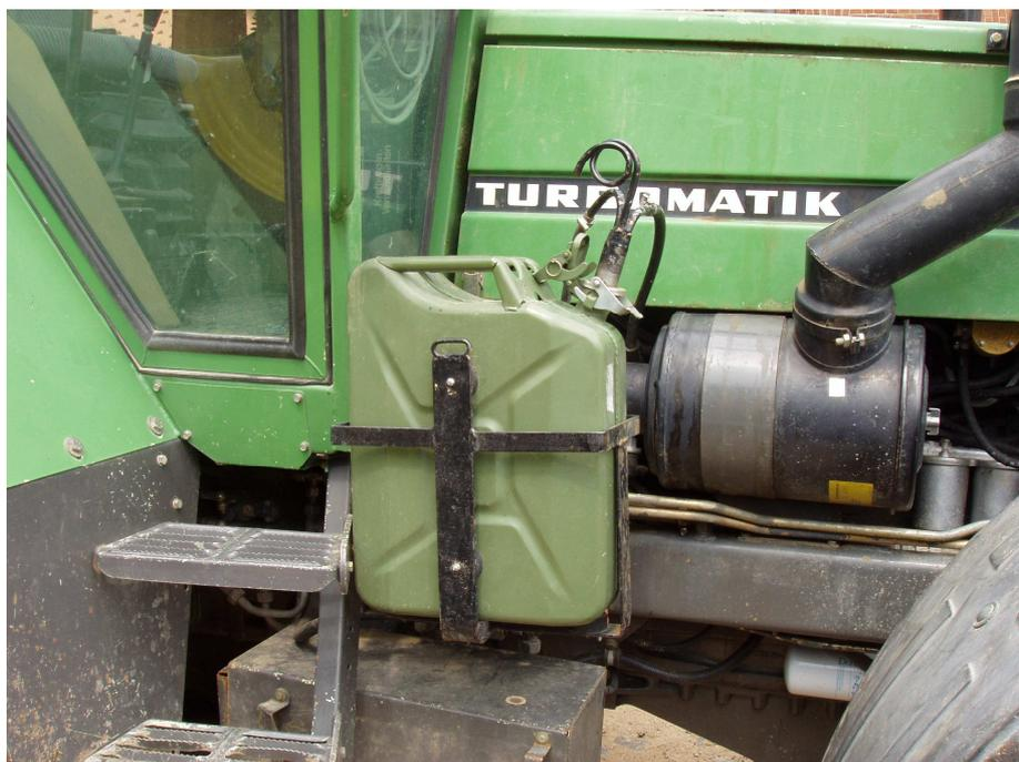
**Abb. 3:** Stahlkanister als Zweittank für Diesel
