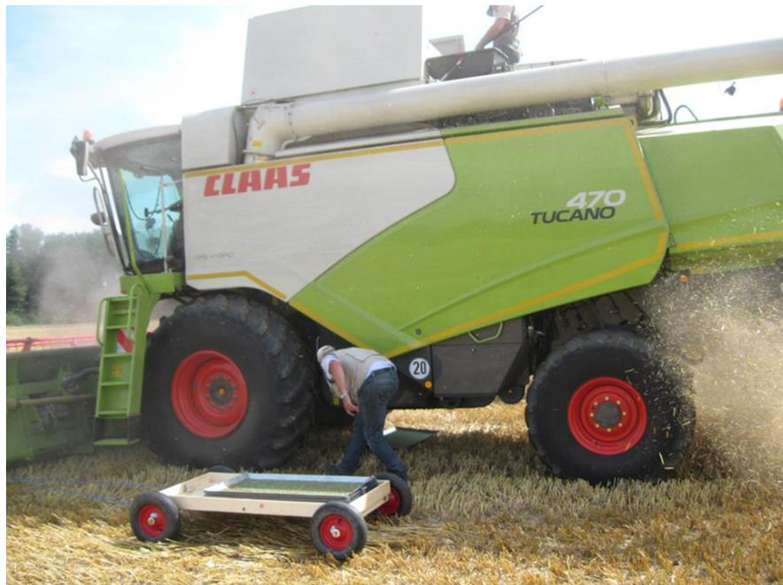
**Abb. 24:** Platzieren der Verlust-Messschalen mittig unter dem Mähdrescher und gleichzeitige Entnahme einer Kornprobe an der Bunkerbefüllschnecke
