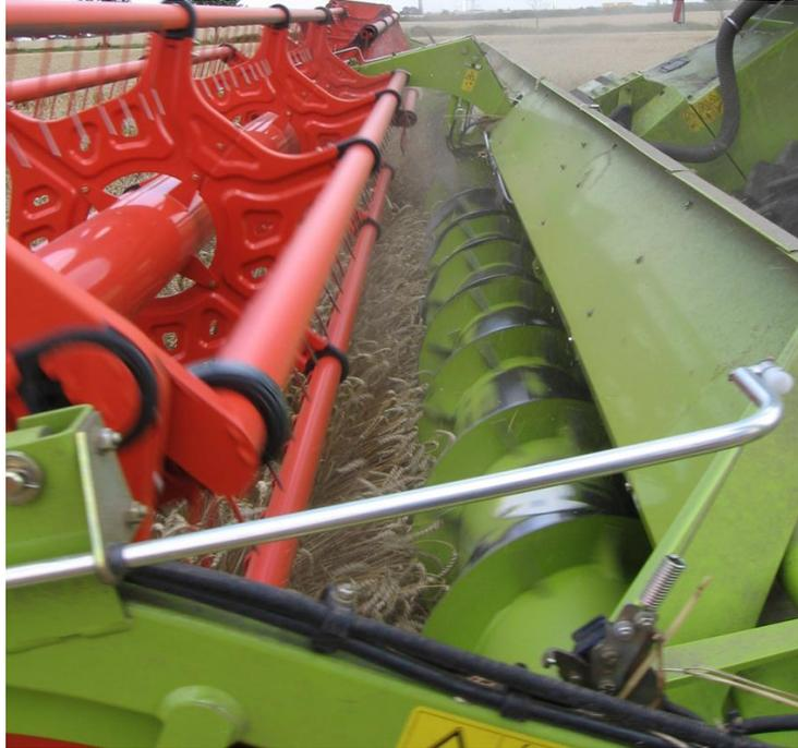
**Abb. 6:** Angepasste Schneidtischlänge für gleichmäßigen Gutfluss – eine Straußbildung vor der Einzugsschnecke ist zu vermeiden
