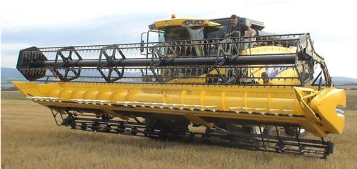
**Abb. 10:** New Holland Doppelschnitt-Schneidwerk (Dual Stream Header) mit walzengeführtem Doppelmesser-Mähbalken hinter der Schneidwerkrückwand (Werkbild New Holland)
