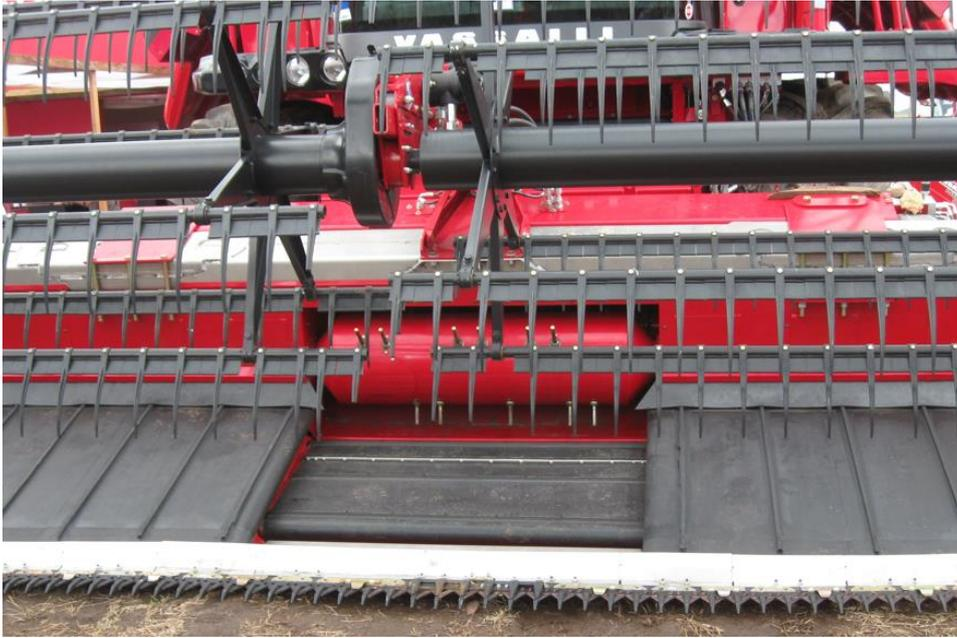
**Abb. 8:** Argentinischer Draper der Fa. Vassalli mit flexiblem Messerbalken sowie kurzem Längsförderband und Einzugsfingerwalze
