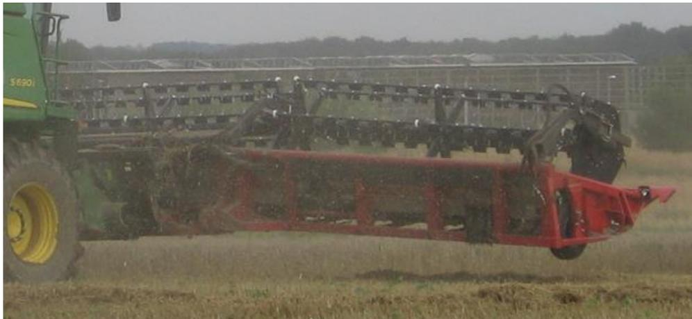
**Abb. 9:** Geringhoff Triflex-Draper mit dreiteiligem Rahmen und dreiteiliger Haspel – im ausgehobenen Zustand neigen sich die stützradgeführten Außenteile
