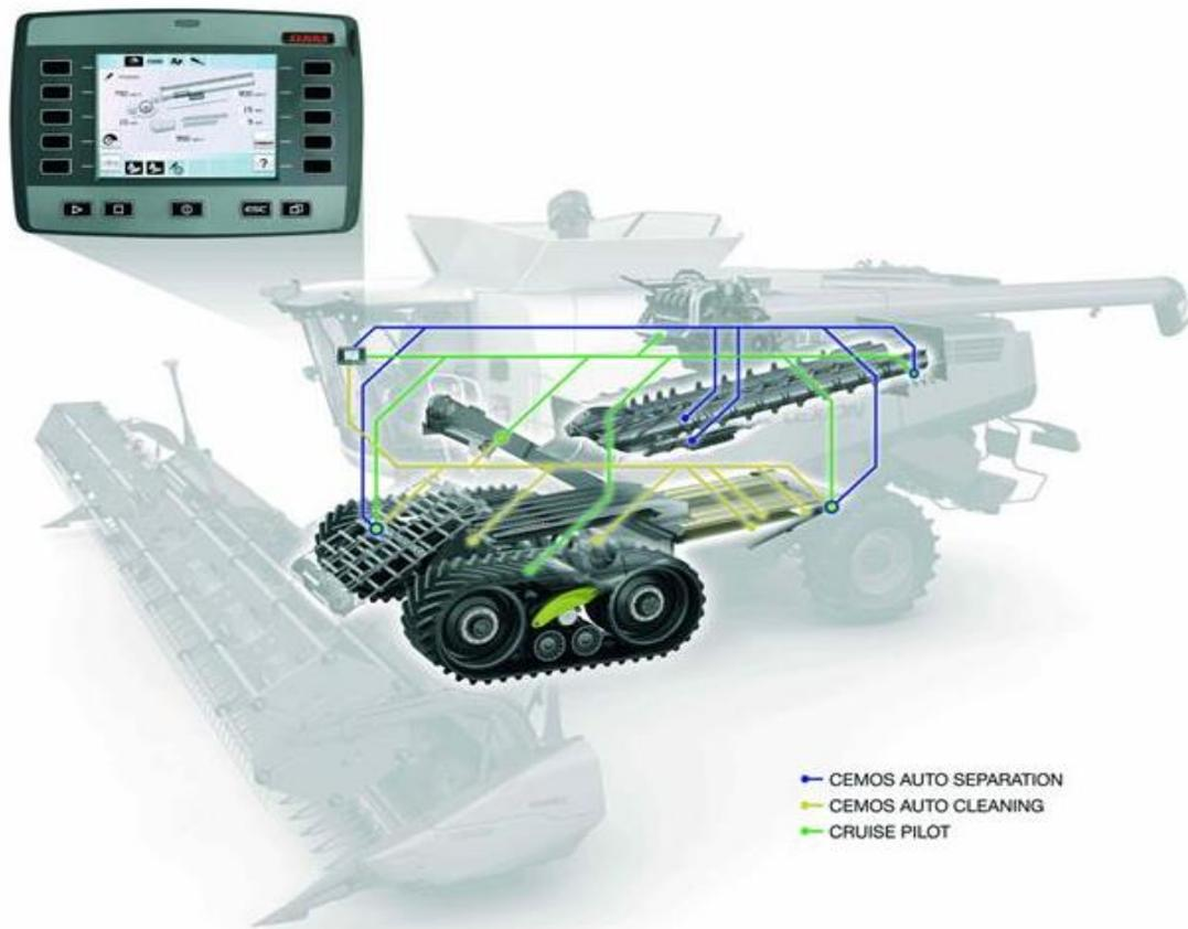
**Abb. 19:** Schema der Funktionsweise des Einstellreglers für die Restkornabscheidung und Reinigung – CEMOS Automatik von Claas (Werkbild Claas)
