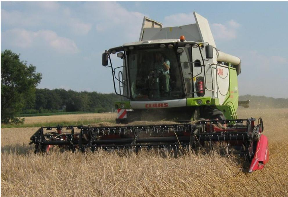
**Abb. 7:** Geringhoff Harvest-Star mit 6 m Schnittbreite in wechselnd liegender Gerste – quasi nahtloser Übergang von Halmteilern zur Seitenverkleidung
