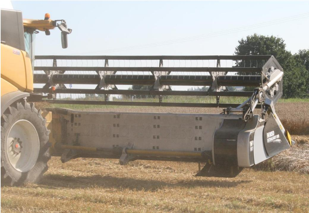
**Abb. 13:** Rückwand des BISO-Ultralight-Schneidwerkes (Version 2009) aus Aluminium
