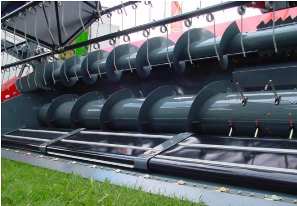
**Abb. 11:** Powerflow-Schneidwerk von MF (alte Version) mit Raps-Leitschnecke über der Einzugsschnecke
