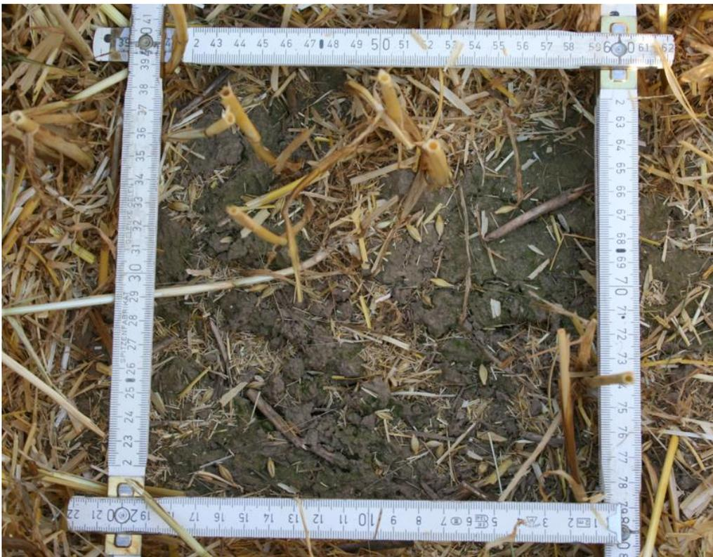
**Abb. 25:** Bewertung von Kornverlusten mit Hilfe eines Zollstockes
