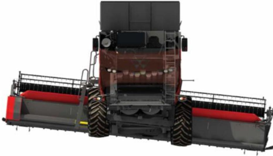
**Abb. 33:** Mähdrescher mit Fahrwerk-Seitenhangausgleich am Seitenhang – Maschine mit Vorderrädern waagrecht, Pendel-Hinterachse bodenparallel (Werkbild Massey Ferguson)
