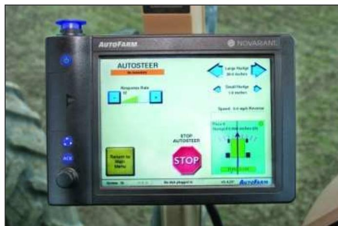
**Abbildung 3:** Touch-Screen zur Bedienung des Autofarm-Systems (Werkbild)
