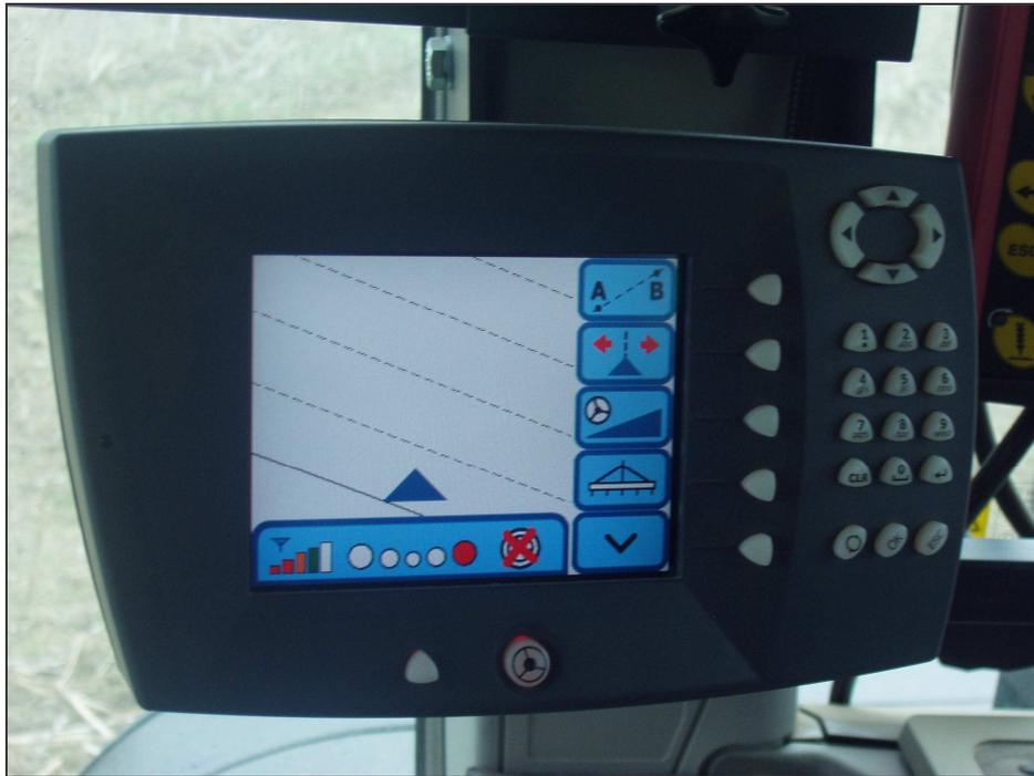
**Abbildung 1:** Bedienterminal des Auto-Guide-Systems von AGCO
