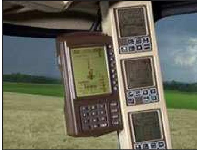
**Abbildung 5:** Greenstar-Terminal zur Bedienung des Parallelfahrersystems
