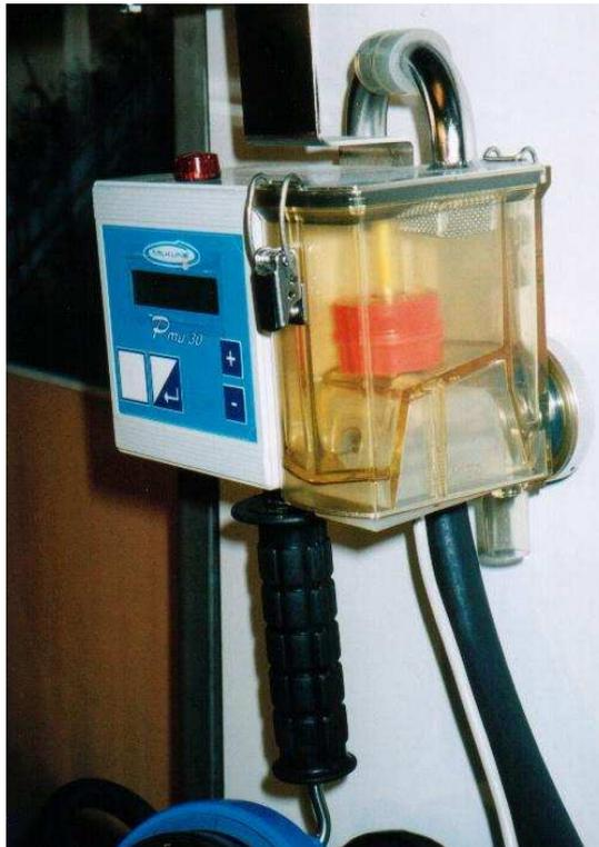
**Abb. 3.11:** Nicht ICAR-erkannte Geräte können zur Melkzeugsteuerung und zur betriebsinternen Überwachung der Milchleistung eingesetzt werden.
