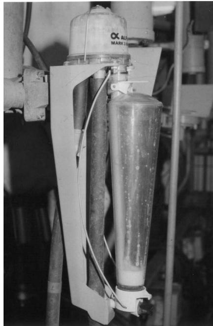
**Abb. 3.2:** Teilmengengeräte können in Anbindestall und Melkstand eingesetzt werden
