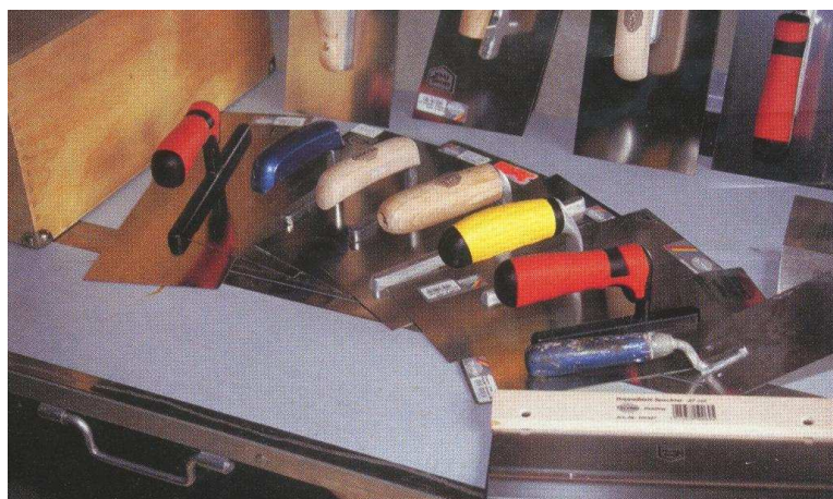
Abbildung 1: Glättkellen und Doppelklingen- Spachtel eignen sich für
