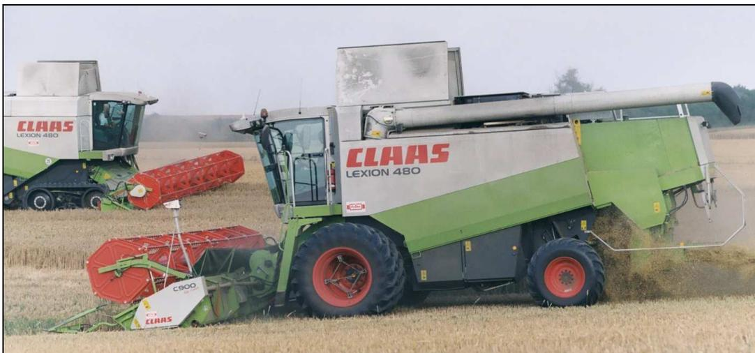
Abb. 8: Claas Lexion 480 mit 9 m Schneidwerk – im Vordergrund Maschine mit Doppelrädern und Allradantrieb, im Hintergrund Gummibandlaufwerk anstelle der Frontreifen
