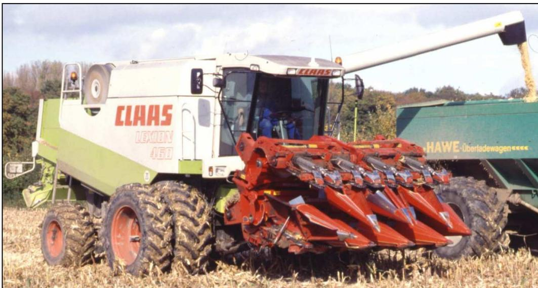
**Abb. 3: Claas Lexion 460 mit 8reihigem Maispflücker, Standard-Frontbereifung 650/73R32 und Doppelrädern 18.4 R 38**
