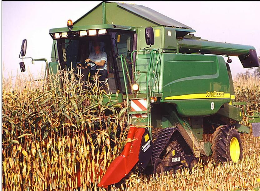
**Abb. 6: John Deere WTS mit Gummibandlaufwerk der Fa. Grecav Spa.**
