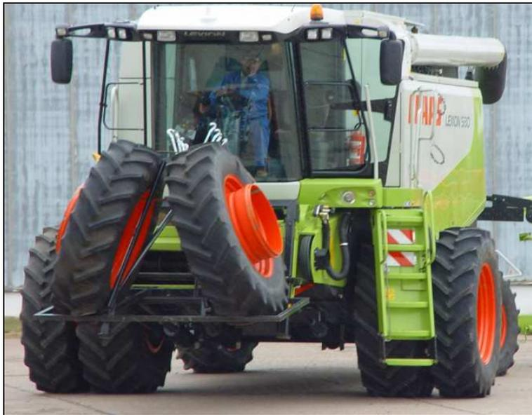
**Abb. 4: Doppelrad-Montage- und Transporthilfe Agrartechnik Grasdorf Wennekamp**
