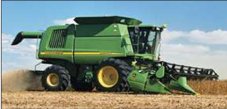
**Abb. 2: John Deere 9560 STS - in den USA mit Doppel-Frontbereifung 4 x 20.8R42 (Werkbild John Deere)**
