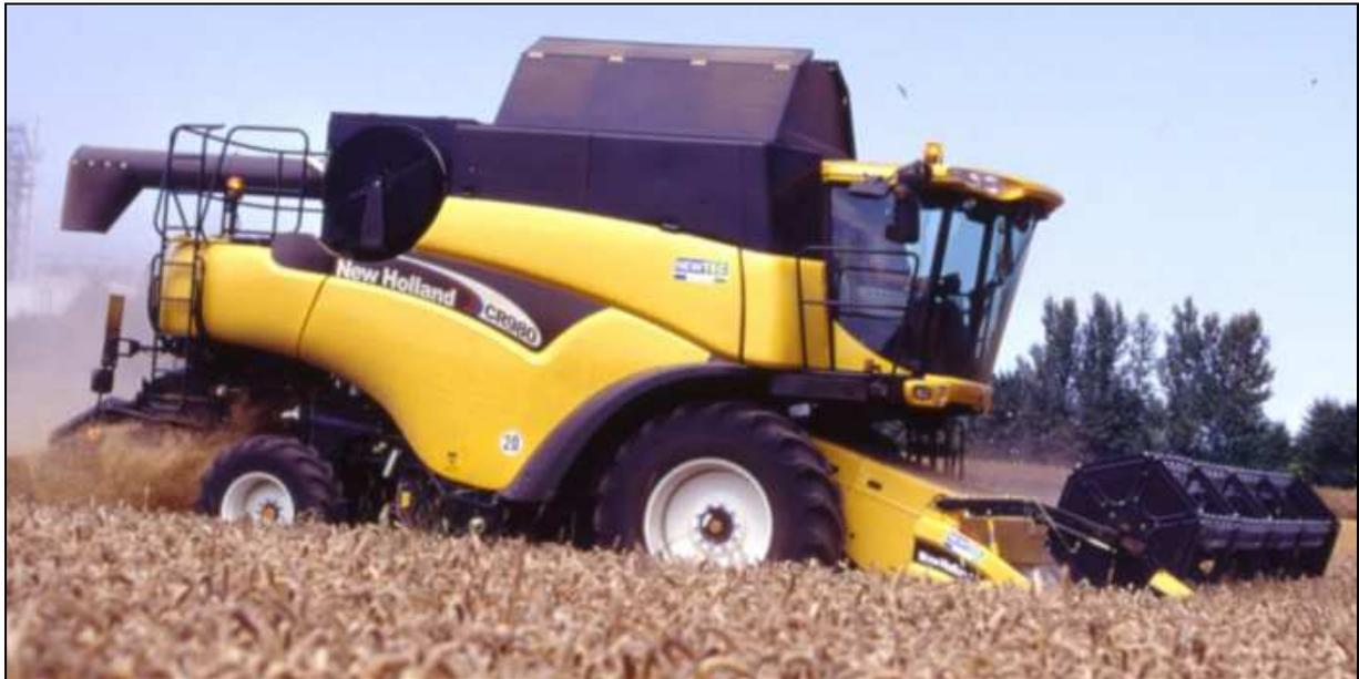
**Abb. 1: New Holland CR 980 mit Standard-Frontbereifung 710/70R38**
