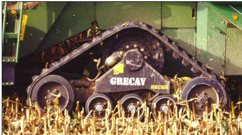
**Abb. 7: Gummibandlaufwerk der Fa. Grecav Spa. – das Antriebsrad wird anstelle des Rades an die Radnarbe geschraubt**
