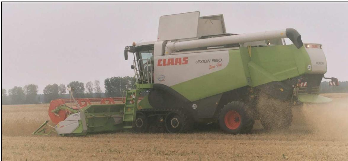
Abb. 5: Claas Lexion 560 mit gefedertem Gummibandlaufwerk
