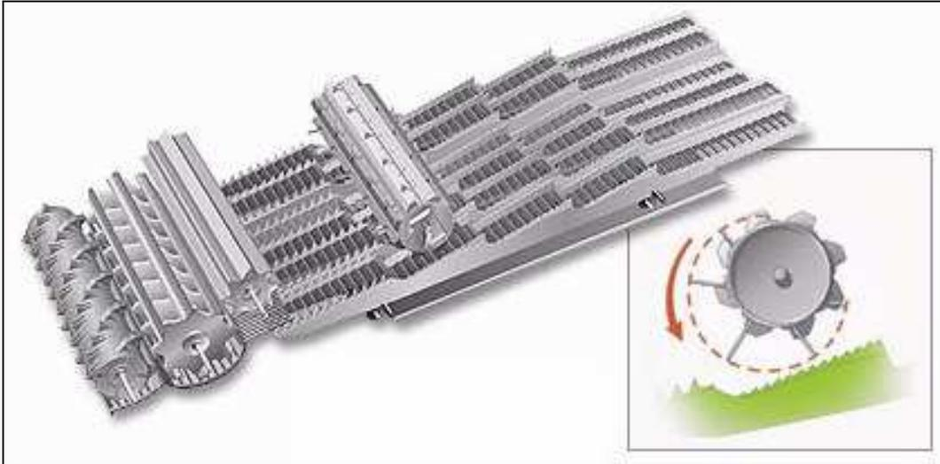
Abb. 11: Multifinger Separator in Claas Lexion Schüttler-Mähdreschern (Werkbild)
