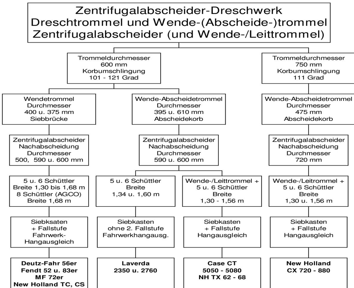
**Abb. 6:** Schüttler-Mähdrescher mit Zentrifugalabscheider-Dreschwerk
