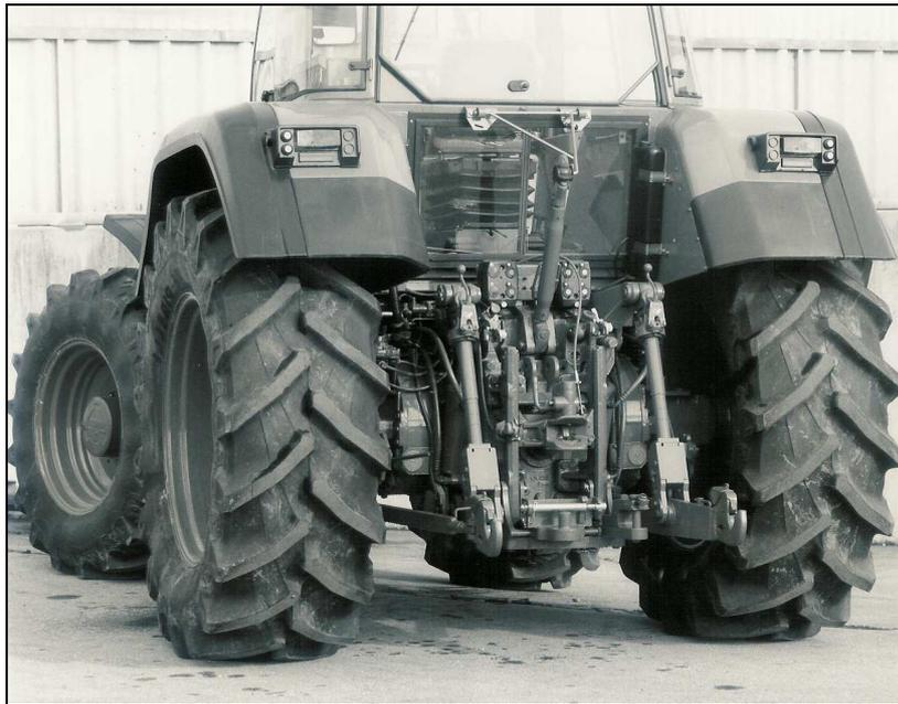
Abb. 3.5: Piton-Fix-Anhängerkupplung an einem Standardtraktor
