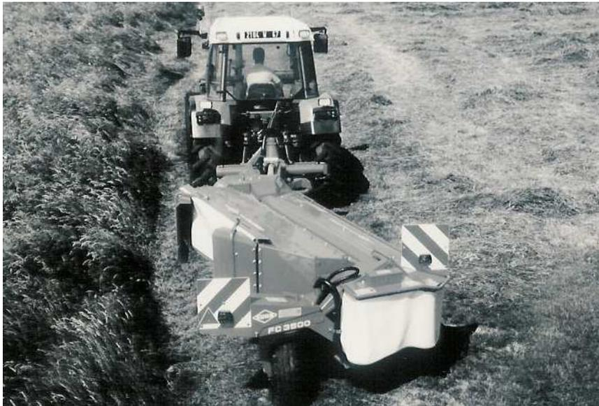
Abb. 6.2: Anhängemähwerk dessen Fahrwerk sowohl für den Straßentransport als auch während der Arbeit genutzt wird
