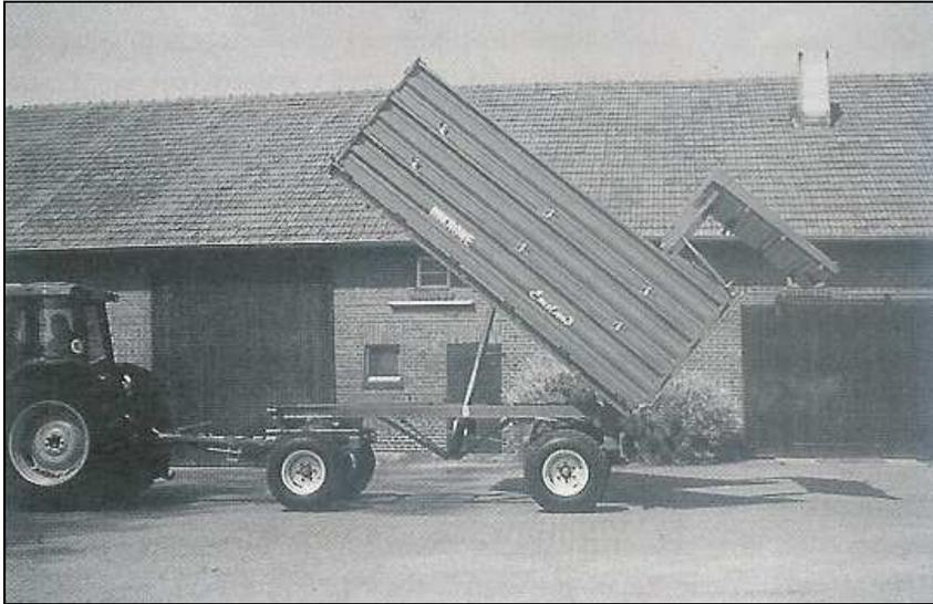
Abb. 5.5: Hydraulische Öffnung der hinteren Bordwand
