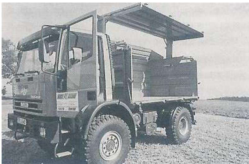
Abb. 5.6: LKW (170 kW) in „Landwirtschaftsausführung“ (Allradantrieb, Geländegänge, Einfachbereifung der Hinterachse) mit Häckselgutaufbau.
