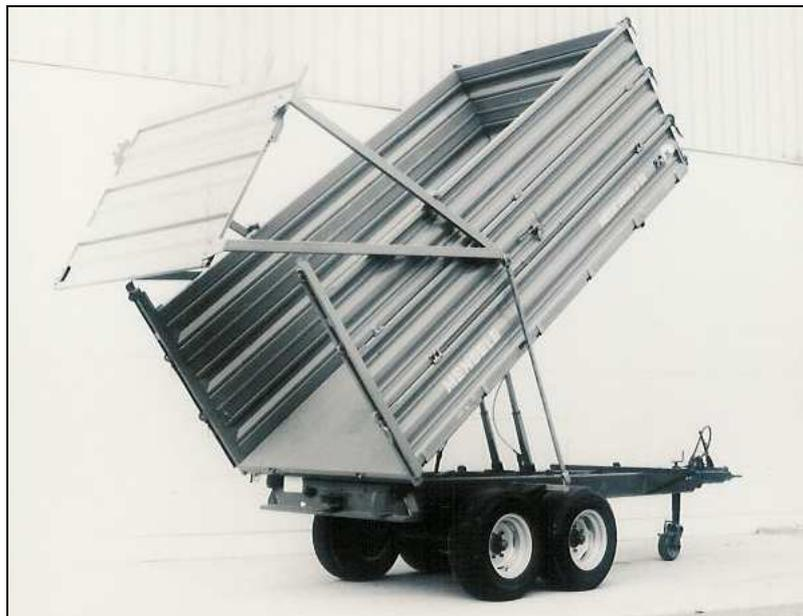
Abb. 5.4: Automatische Öffnung der Heckklappe
