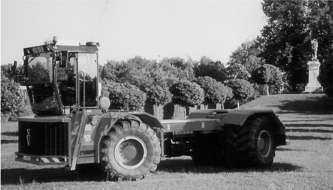
Abb. 5.7: Feldtransportfahrzeug für Wechselaufbauten: Holmer: „Terra Variant“
