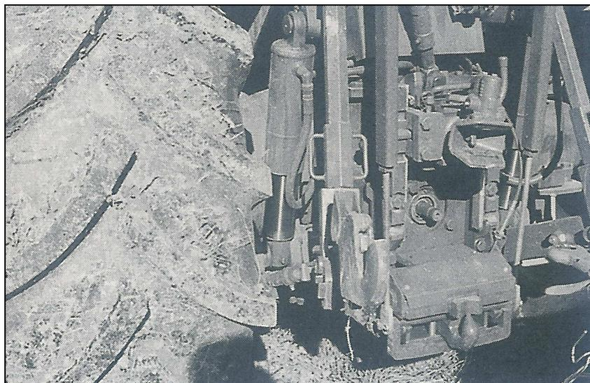
Abb. 3.4: Hitchanhängerkupplung an einem Standardtraktor
