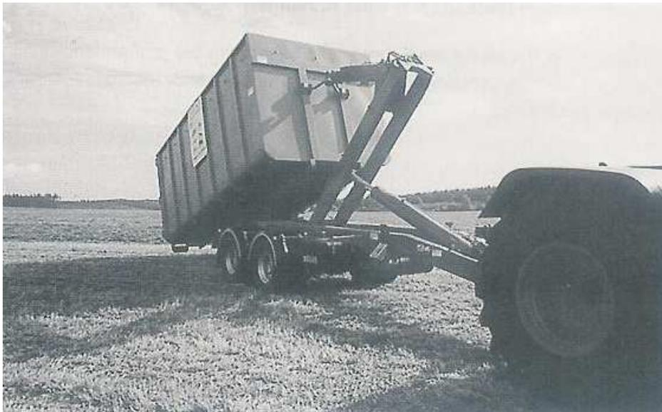
Abb. 5.8: Anhänger mit Abrollcontainer
