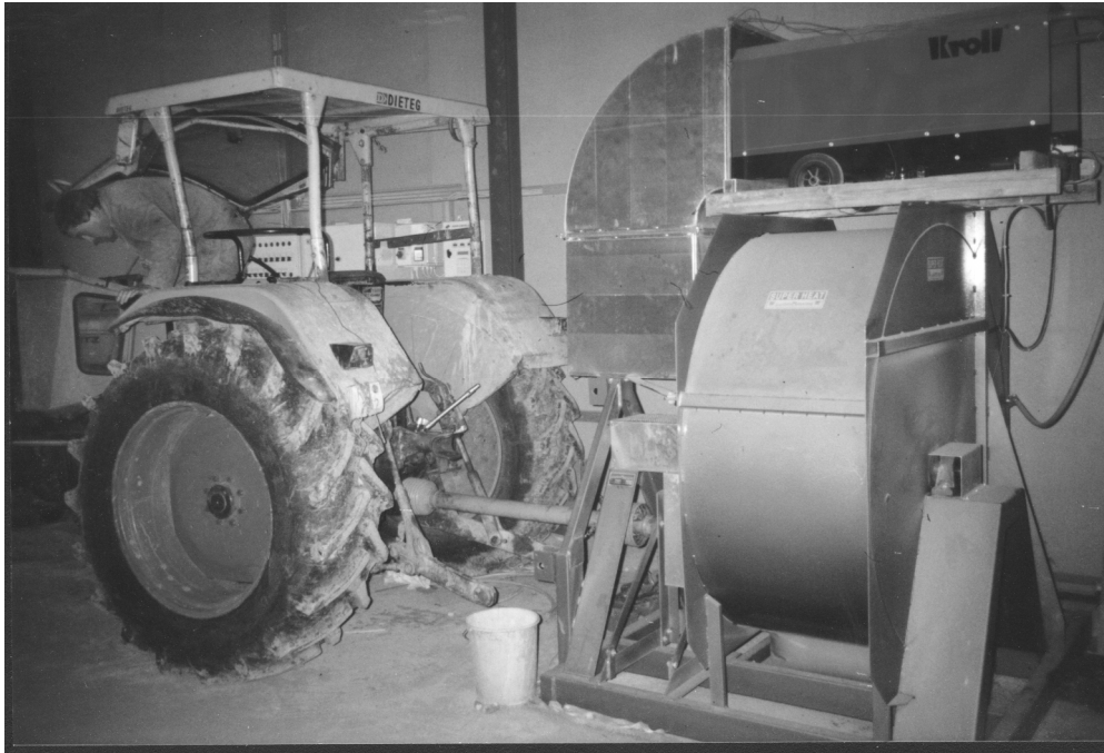
Abbildung 16: Schleppergetriebene Gebläse können die Abwärme des Schleppers nutzen. Hier mit zusätzlich aufgebautem Gas-Warmlufterzeuger.
