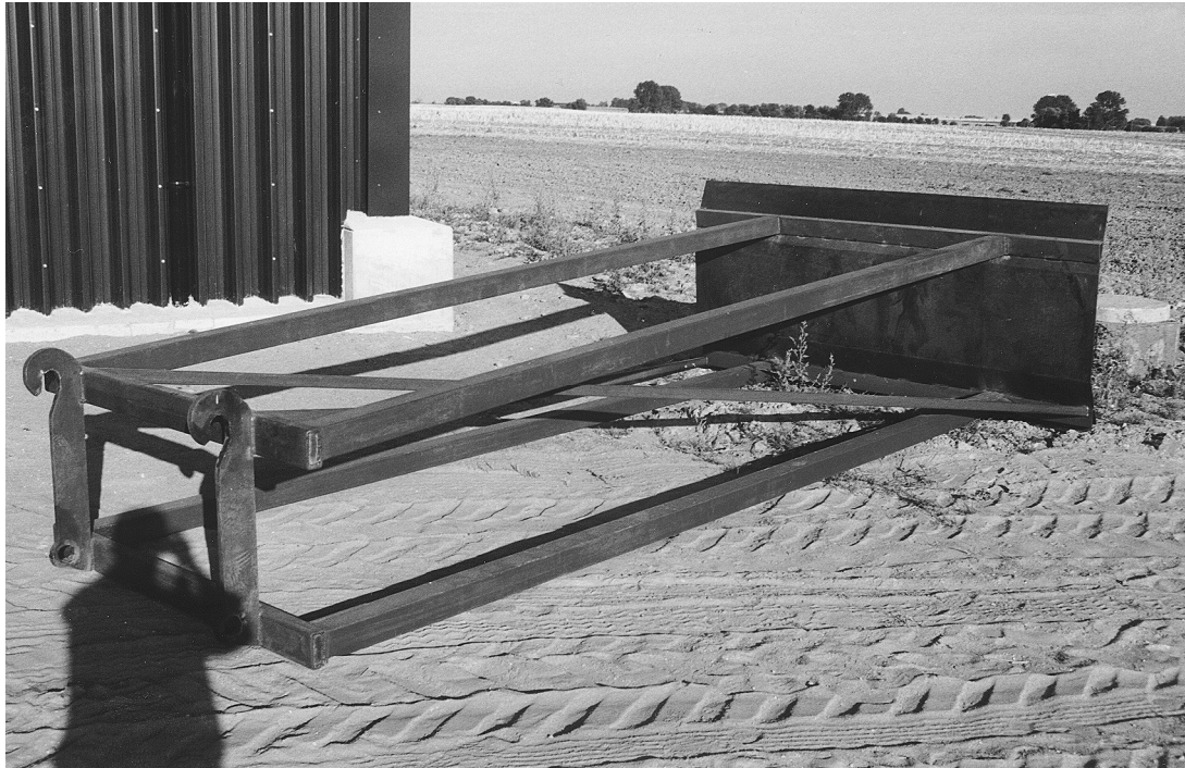
Abbildung 10: Selbstgebautes Schiebeschild für die Befüllung von Getreide-Flachlagern zum Anbauen an einen Radlader
