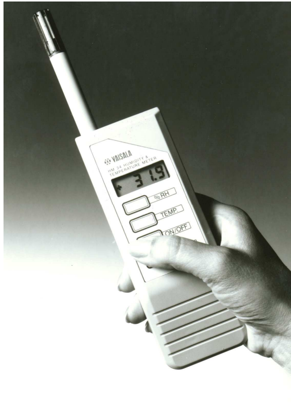
Abbildung 35: Vaisala-Handmeßgerät (HM 34) für relative Luftfeuchte und Temperatur. Vertrieb: Driessen und Kern GmbH, 24572 Bad Bramstedt, Tel. 04192-9814, Fax: 04192-7321
