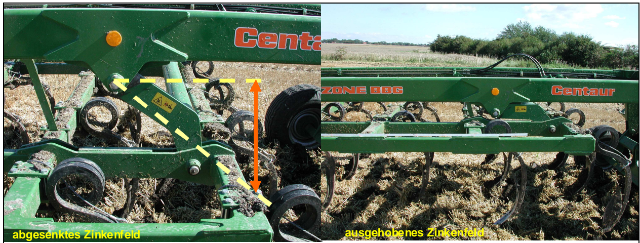
Abb. 8: Die Tiefe der Grubber-Baugruppe wird stufenlos hydraulisch verstellt
