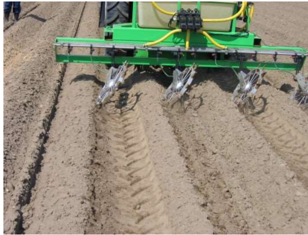
Abb. 12: Einsatz des Injektionsgerätes zur Injektion in Kartoffeldämme mit 45° geneigten Sternrädern
