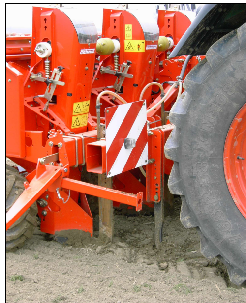
Abb. 9: Position Injektion vor dem Furchenzieher
