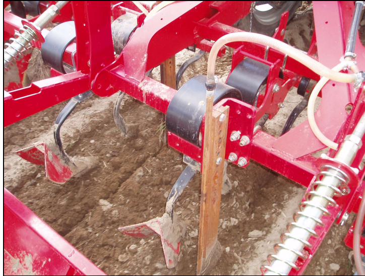
Abb. 11: Position Injektionsschar im Häufelgerät
