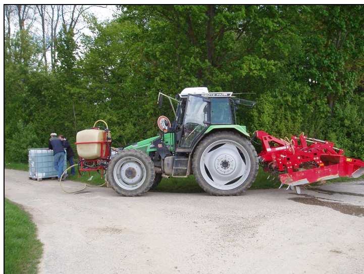
Abb. 10: Konzept Injektion beim Häufeln
