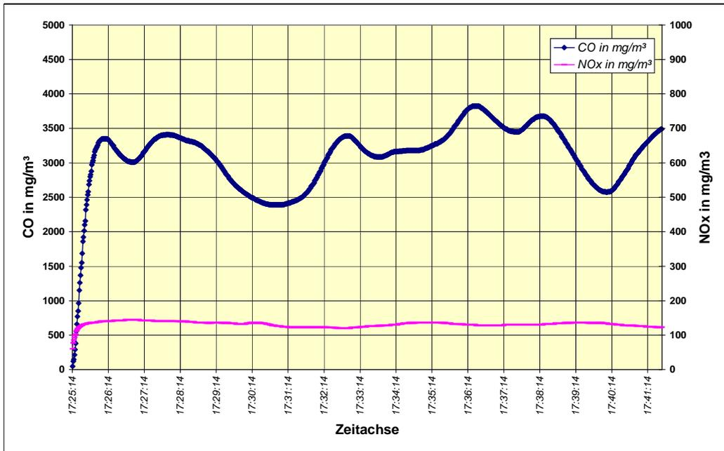
Abbildung 25: CO- und NO<sub>x</sub>-Emissionen Strohpellets Veto Kessel
