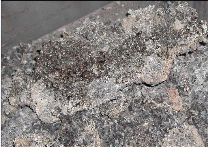
**Abbildung 30: Strohpelletschlacke**
