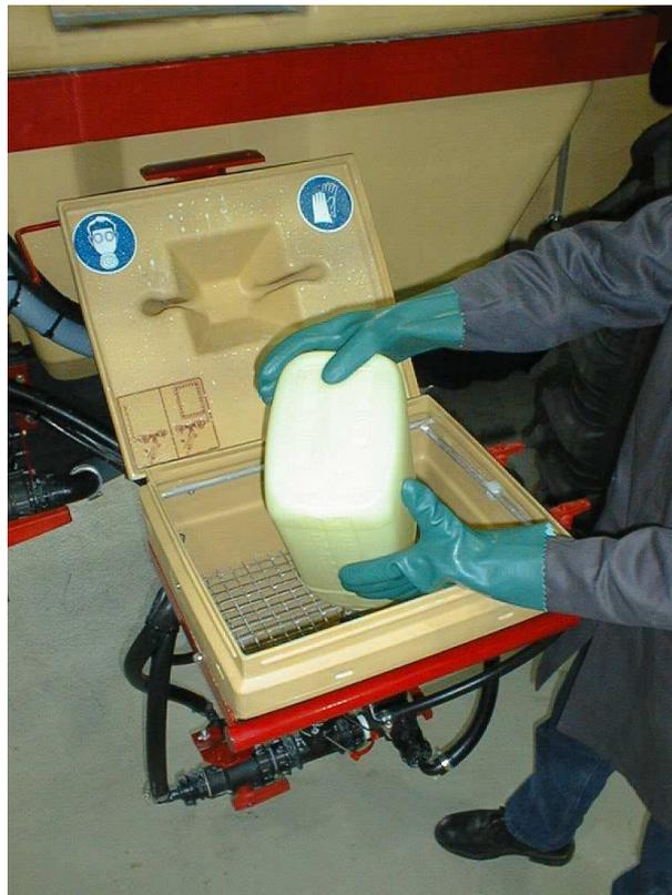
**Abbildung 1:** Ausreichend dimensionierte Einspülschleuse mit Gebindespüleinrichtung und Einspülringleitung in angenehmer Arbeitshöhe.
