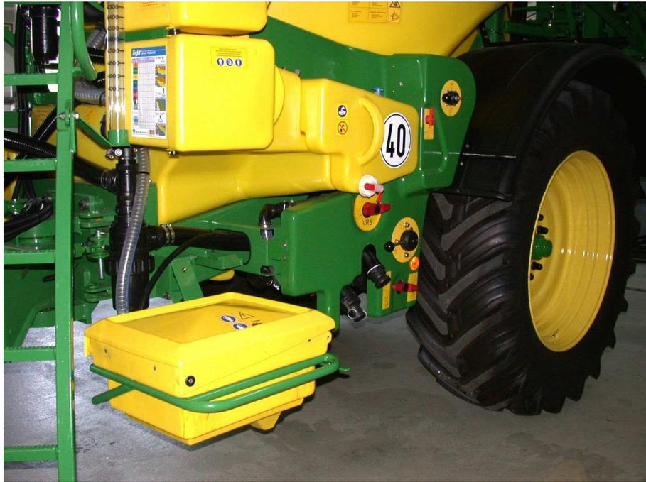
**Abbildung 3:** Ein weiteres gutes Beispiel für ein Bedienzentrum. Hier wurden zusätzlich die Einspülschleuse und Transportbehälter für die persönliche Schutzkleidung integriert.
