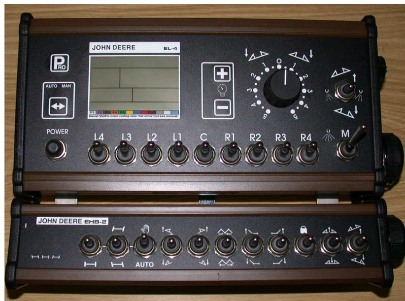
**Abbildung 5:** Regeleinrichtung mit kombinierter Fernbedienung in konventioneller Ausführung mit Kippschaltern für die Gerätesteuerung (Teilbreitenschaltung, Hydraulikfunktionen).
