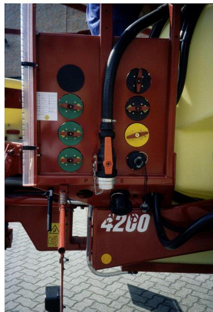
**Abbildung 2:** Bedienzentrums mit farblich gekennzeichneten Vorwählhähnen zur Druck- und Saugsystemsteuerung sowie leicht erreichbaren Anschlüssen für die Gerätebefüllung. Links im Bild die gut ablesbare Füllstandsskala.
