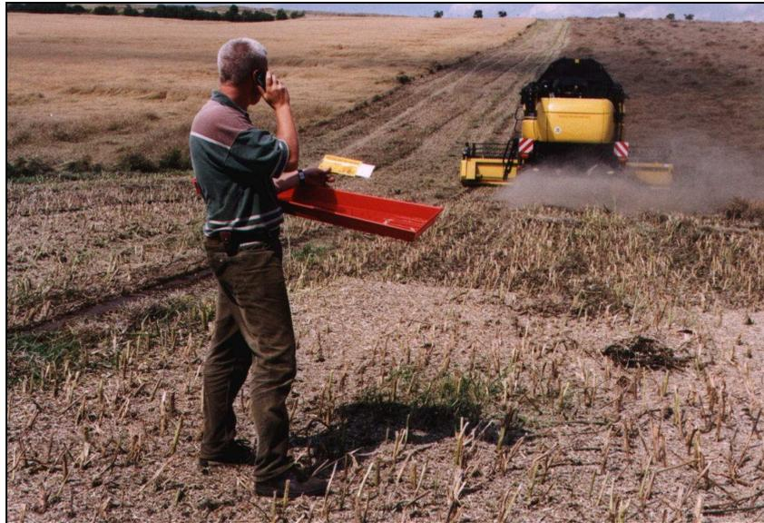
**Abb. 36:** 1 % Druschverluste sind bei Stroh- und Spreuverteiung ca. 150 Körner/1/4 m<sup>2</sup>
