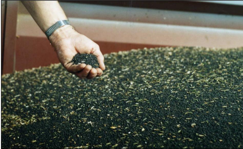
**Abb. 37:** Hohe Fahrgeschwindigkeit steigert das Strohpolster und senkt den Bruchkornanteil
