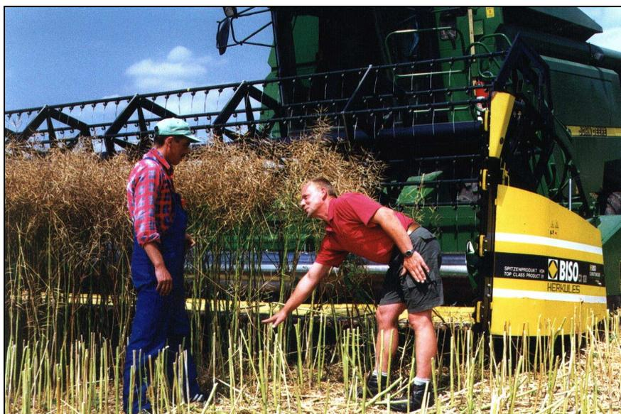
**Abb. 25:** Schneidwerk unter dem Schotenpaket ansetzen
