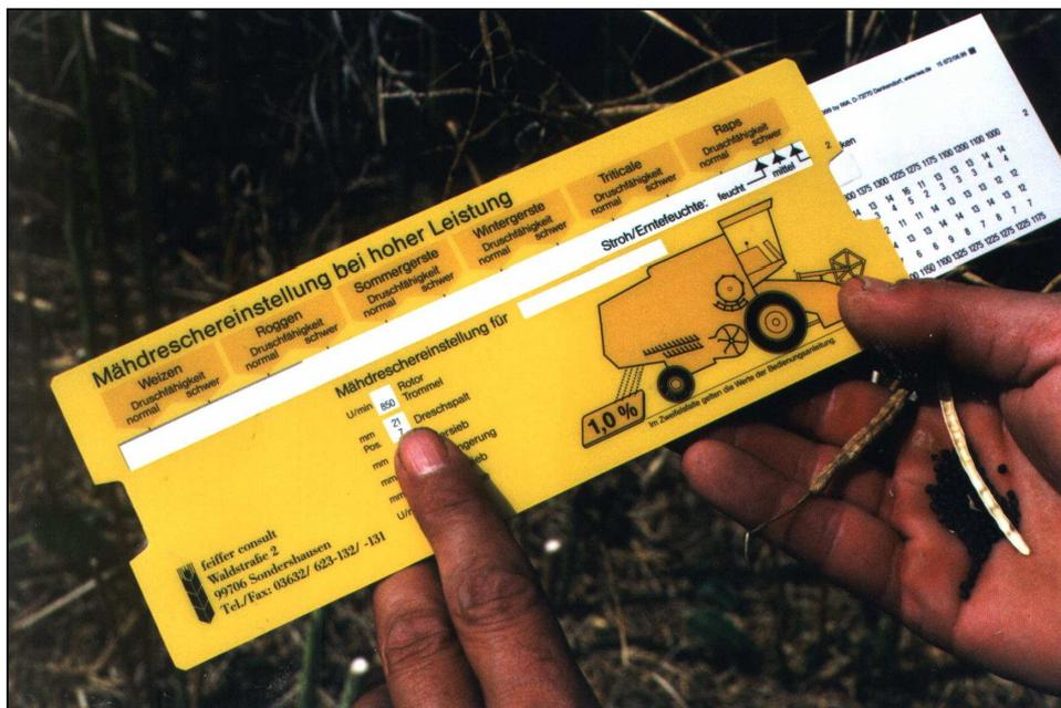
**Abb. 30:** Fegeeffekt bei feuchtem Druschgut nutzen: Trommeldrehzahl rauf, Korb runter
