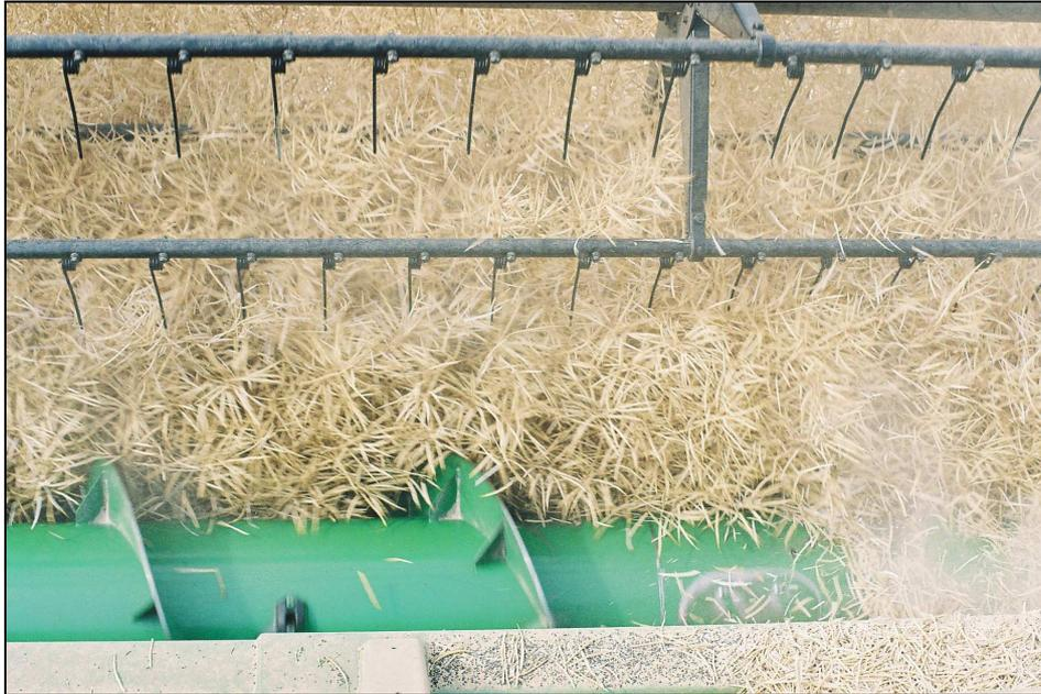
**Abb. 29:** Nur das Schotenpaket schneiden und einziehen
