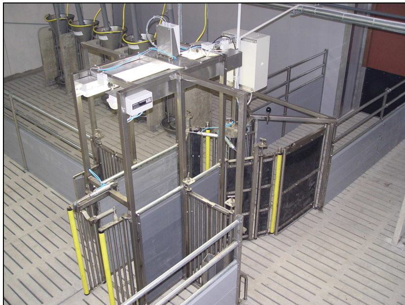
Futterstand mit integrierter Selektionseinrichtung zur individuellen Tierbetreuung im Mastschweinebereich (Werkbild Hölscher + Leuschner)
