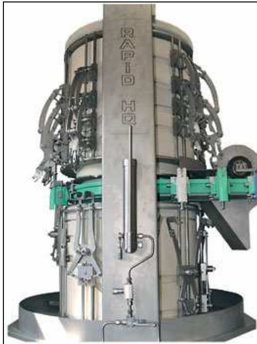
Automatische Anlage zum Filettieren und Knochenentfernen von Broilerhälften (Werkbild Meyn)
