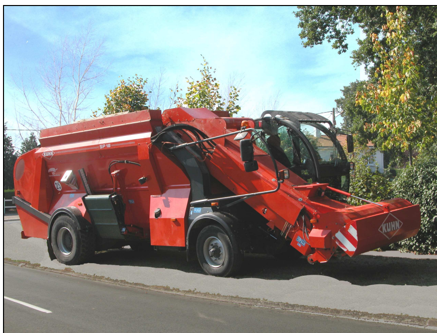
Selbstfahrender Fräsmischwagen mit horizontalen Mischschnecken aus den USA (Werkbild Kuhn)
