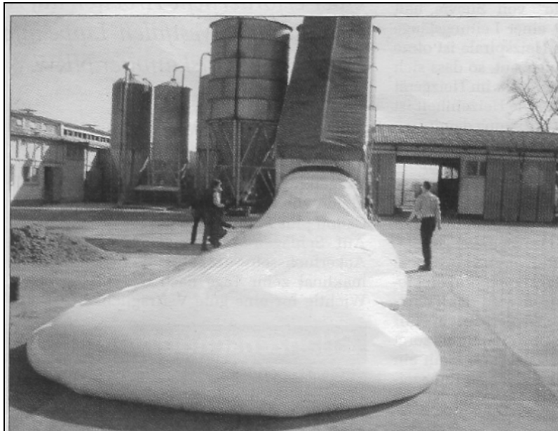
Schlauchsilageverfahren für Biertreber ohne zusätzliche Vorpressung (Werkbild AG-Bag)
