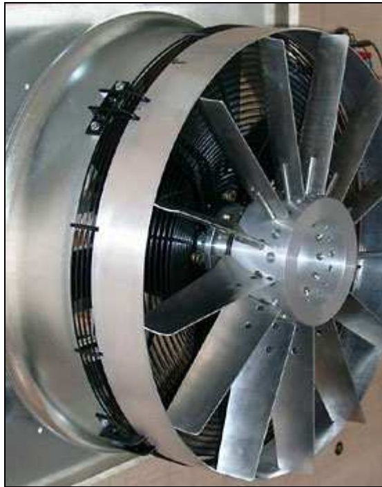
Nachleitrad für Axialventilatoren zur Erhöhung der Wurfweite in der Abluft (Werkbild Ziehl-Abegg)
