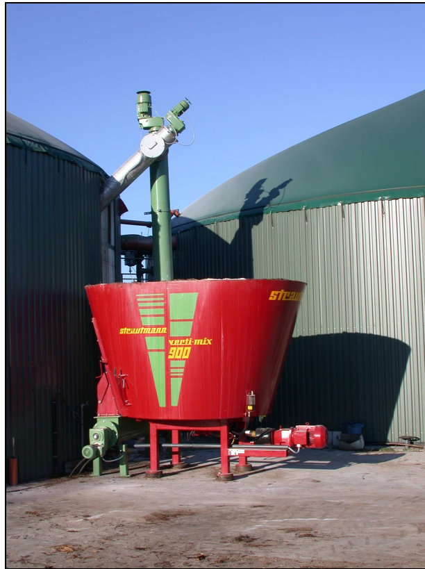
Feststoffeinbringsystem für Biogasanlagen bei dem der Mischbehälter und die nachgelagerten Förderschnecken konstruktiv aufeinander abgestimmt werden. (Werkbild Strautmann)
