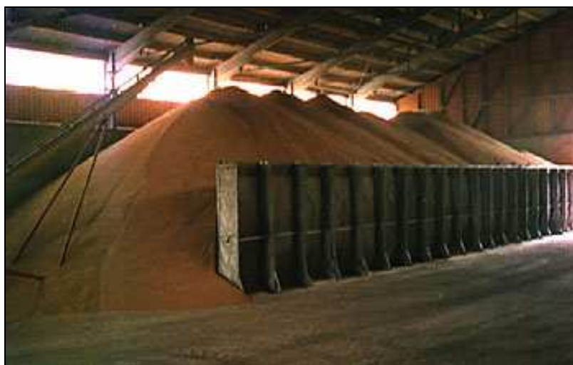
Mobile Schüttwand für Getreide-Flachläger aus seitlichen Stahlelementen und Kunststoffgewebe als Wandmaterial (Werkbild Agrotel)
