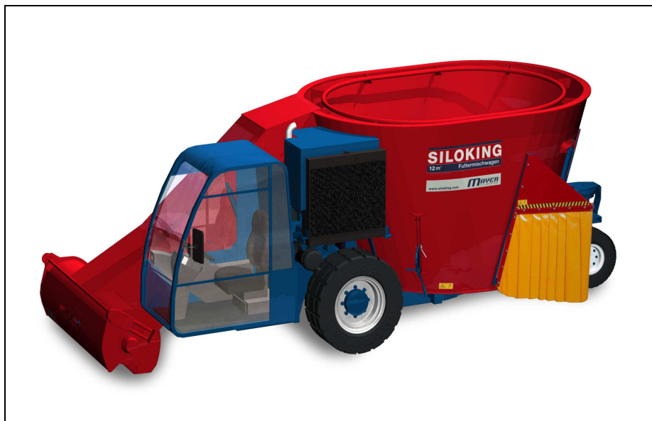
Selbstfahrender wendiger, dreirädriger Fräsmischwagen mit vertikaler Mischschnecke und beidseitigem Futterauswurf während einer Stalldurchfahrt (Werkbild Mayer)
