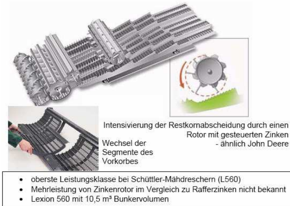
Abb. 10: Beschreibung des Systems Claas Lexion-Schüttler (Werkbilder Claas)
