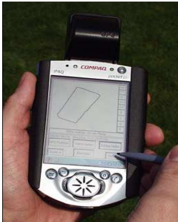
Abb. 14 Compaq Ipaq Pocket-PC mit CF-GPS-Empfänger und Goodsoil VN Flächenaufmaßsoftware
