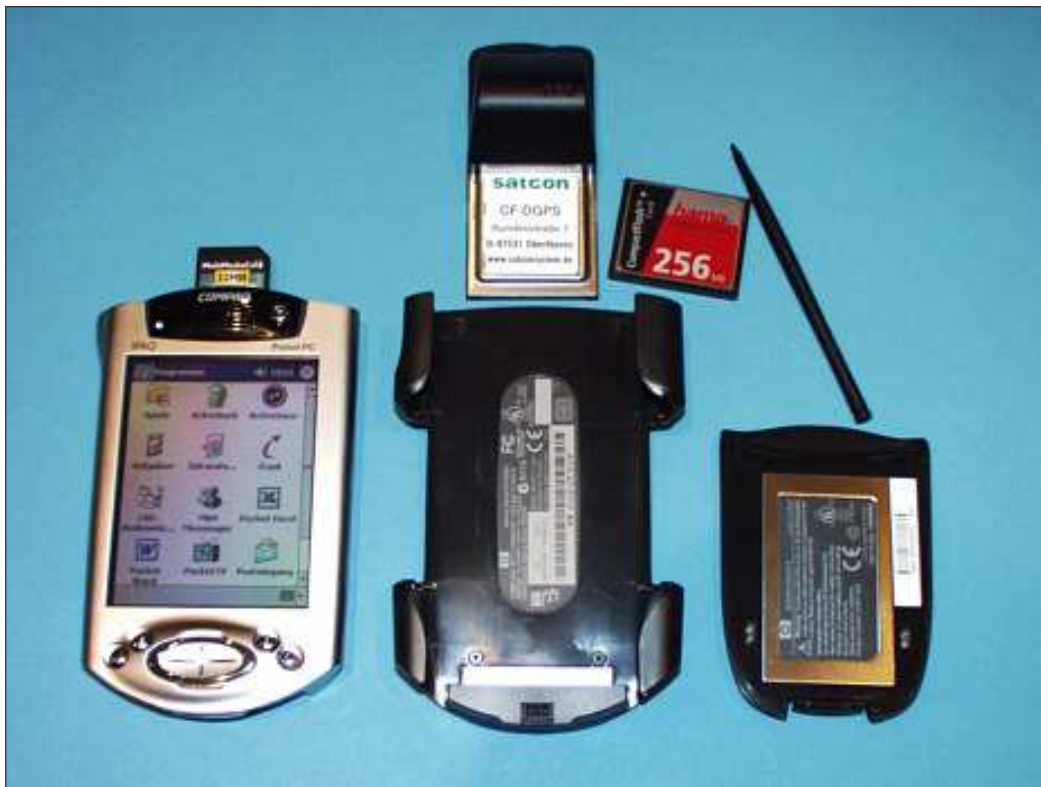
Abbildung 5 HP (Compaq) Ipaq mit „Erweiterungs“-Jacket, CF-Speicherkarte mit 256 MB, GPS-Empfänger und Zusatzakku
