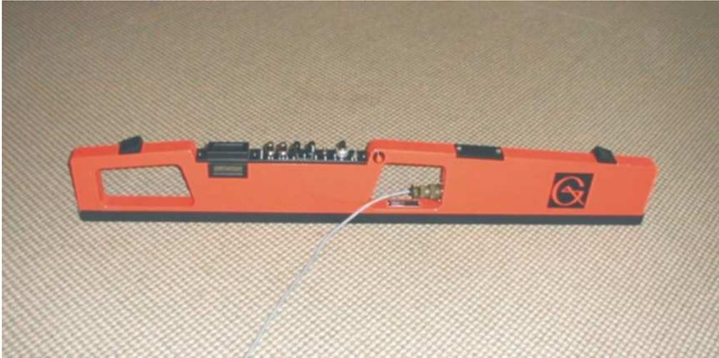
**Abb. 1:** EM 38 Messgerät der Firma Geonics in Kanada
