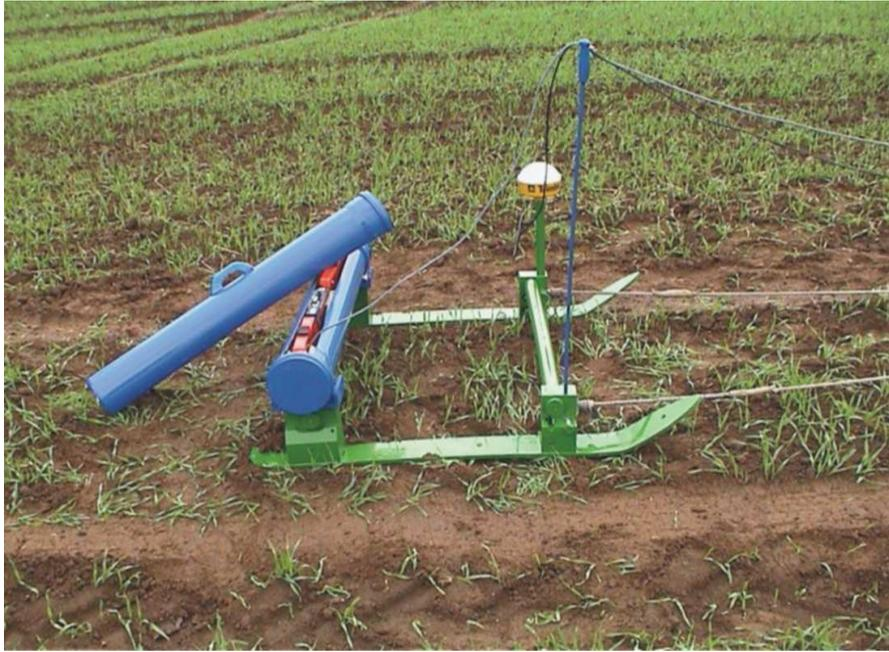
**Abb. 2:** Messschlitten für das EM 38
