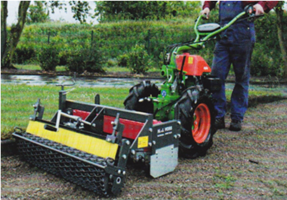
Abb. 3: Wildkrautegge, speziell für wassergebundene Wege
