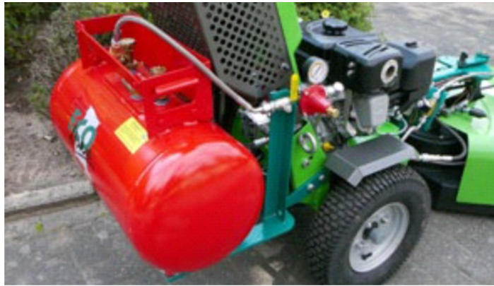
Abb. 5a: Adler Combi Compact mit LPG-Gastank
