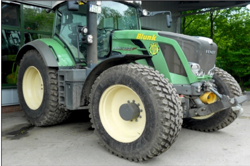
Abbildung 2: Versuchstraktor Fendt-Vario 828 mit Industriebereifung (TRI2 von Nokian)
