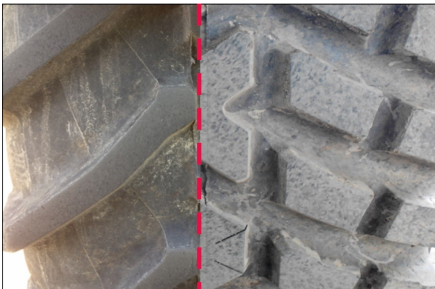
Abbildung 3: Vergleich von AS-Bereifung (links) und Industriebereifung (rechts)
