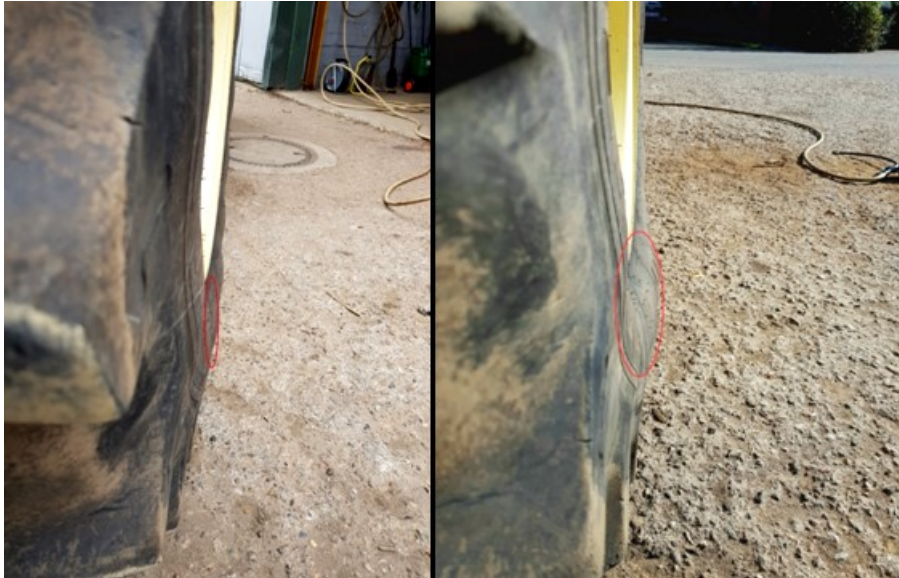
Abbildung 7: Reifenverhalten bei Druckänderung auf (links) 2,0 bar und (rechts) 1,4 bar (Domscheit, 2018)
