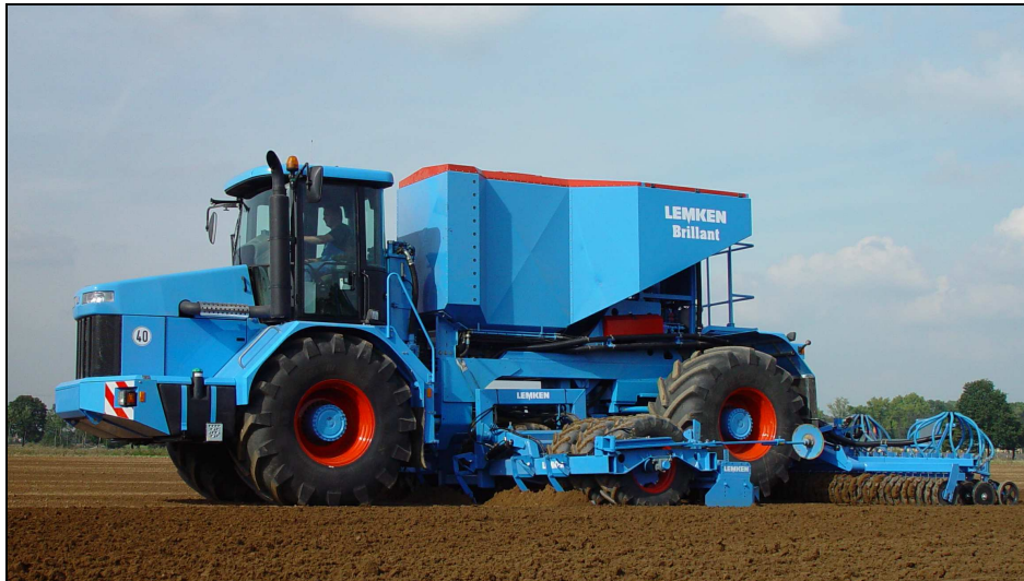
Selbstfahrende Bestellsaatmaschine mit angetriebener Packerwalze (Werkbild Lemken)
