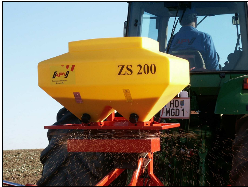
Zweischeiben-Universalstreuer für Schneckenkorn mit Streubreiten auch über 24 m (Werkbild APV)
