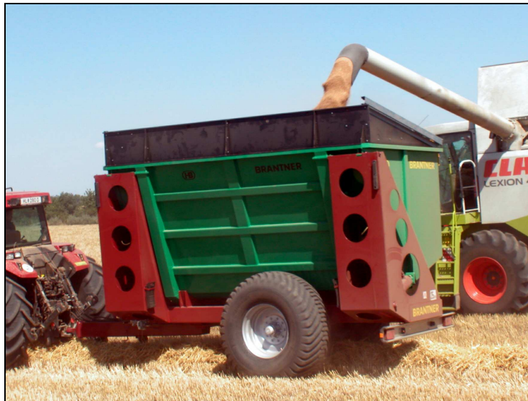
Überladewagen ULW 20 mit hydraulischem Kippbunker (Werkbild Brantner)
