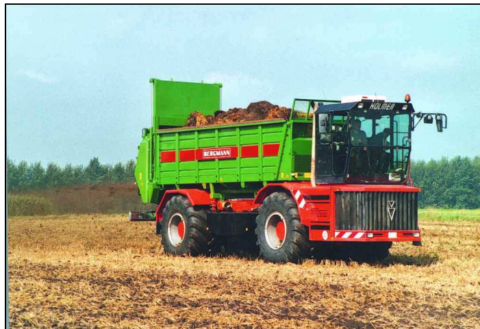
Streueraufsatz für Holmer-Allrad-LKW (WerkbildBergmann)
