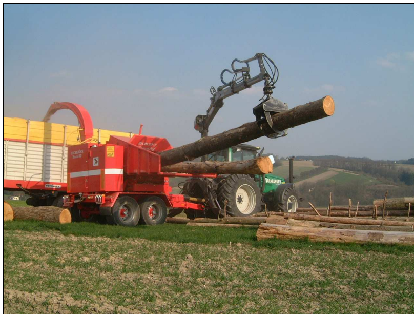
Leistungsfähiger Holzhacker (Werkbild Eschlböck)
