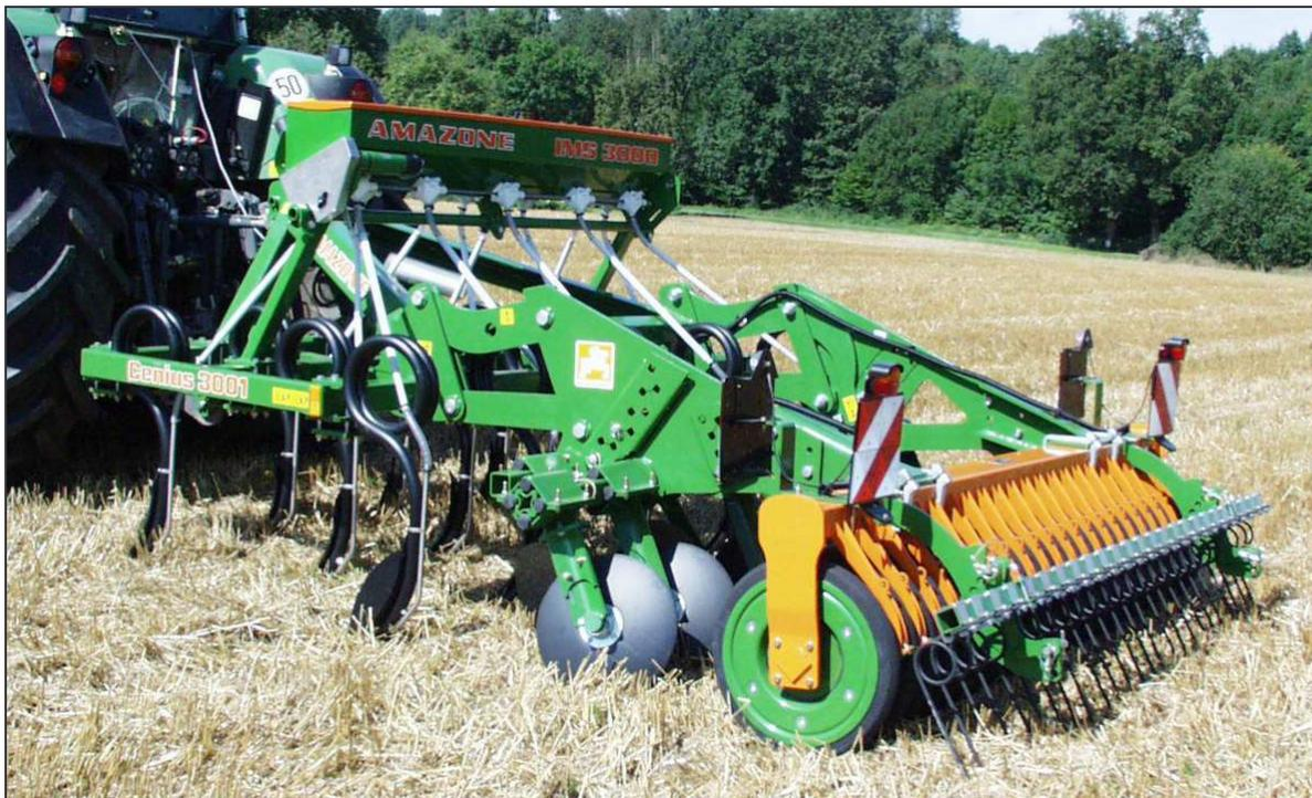
**Abbildung 4-1:** Genius–Mulchgrubber mit integrierter Düngetechnik (Werkbild Amazone)
