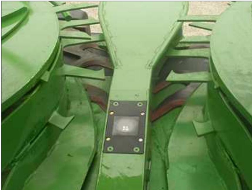
**Abbildung 2-3:** Krone Fotosensor im Maisgebiss zur Reifegradbestimmung bei Silomais
