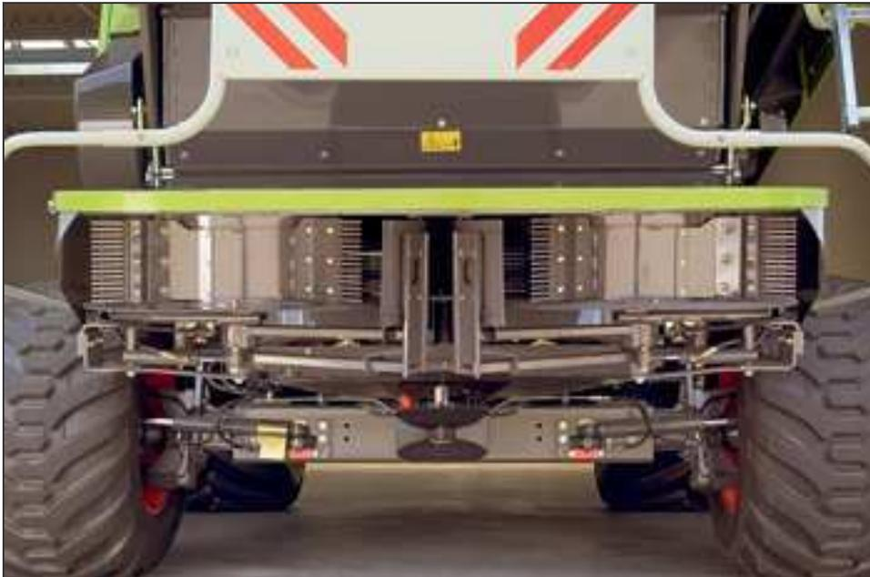
**Abbildung 12-1:** Stroh-/Spreuverteilung am Claas mit zusätzlichen Wurfrotoren
