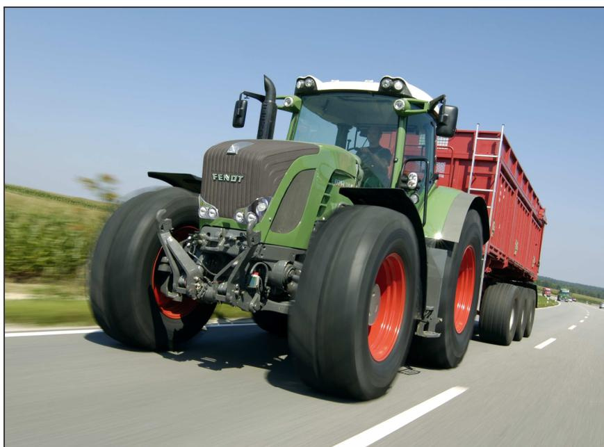
**Abbildung 1-1:** Der Fendt 936 ist als Schnellläufer für 60 km/h konzipiert
