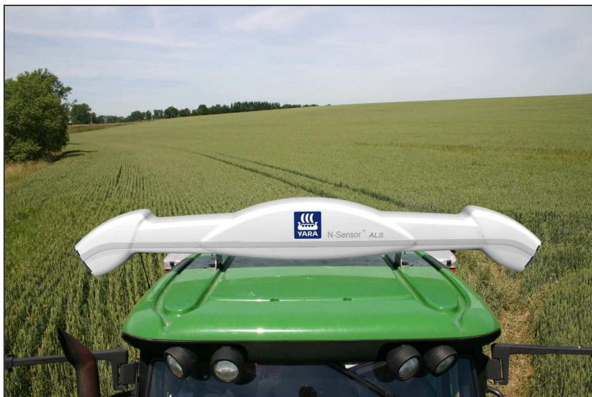
**Abbildung 2-1:** Der neue YARA N-Sensor ALS – neues Design und neue Technik kann jetzt auch 24h am Tag zur Stickstoffdüngung eingesetzt werden (Werkbild AgriCon)
