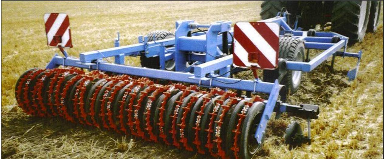
**Abbildung 4-3:** Terraflow – die aktive Walze für Grubber und Scheibeneggen
