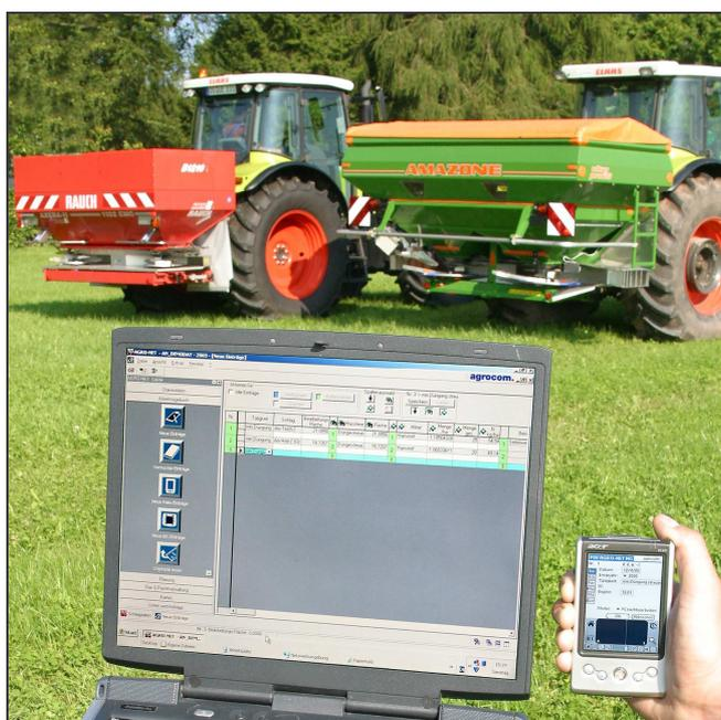
**Abbildung 2-2:** Automatische Schlagbezogene Dokumentation ASD – mit Handheld und Rauch/Amazone und Agrocom
