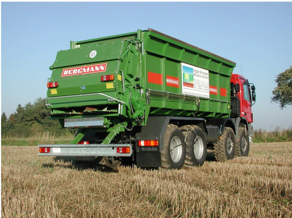
**Abbildung 8-2:** LKW mit TTS-Exaktausbringung (Werkbild Bergmann)
