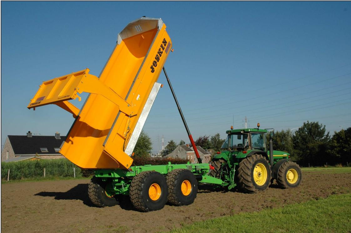
**Abbildung 3-1:** Tiefbaukipper aus HARDOX Stahl der Firma Joskin
