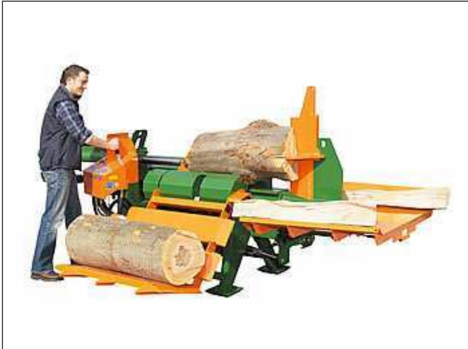
**Abbildung 16-2:** Kombination aus Säge und Spaltmaschine (Werkbild Posch)
