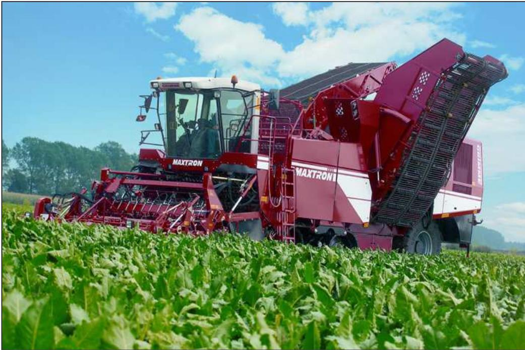
**Abbildung 13-1:** Der hydraulische Hangausgleich lässt die Maschine auch bei Hängen von  $\pm 5^\circ$  noch waagrecht stehen (Werkbild Grimme)
