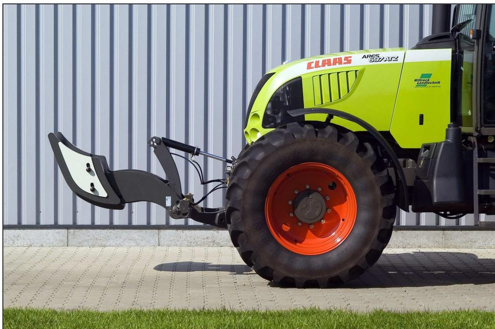
**Abbildung 1-3:** Variables Frontanbaugewicht für Claas und andere Schlepperfabrikate
