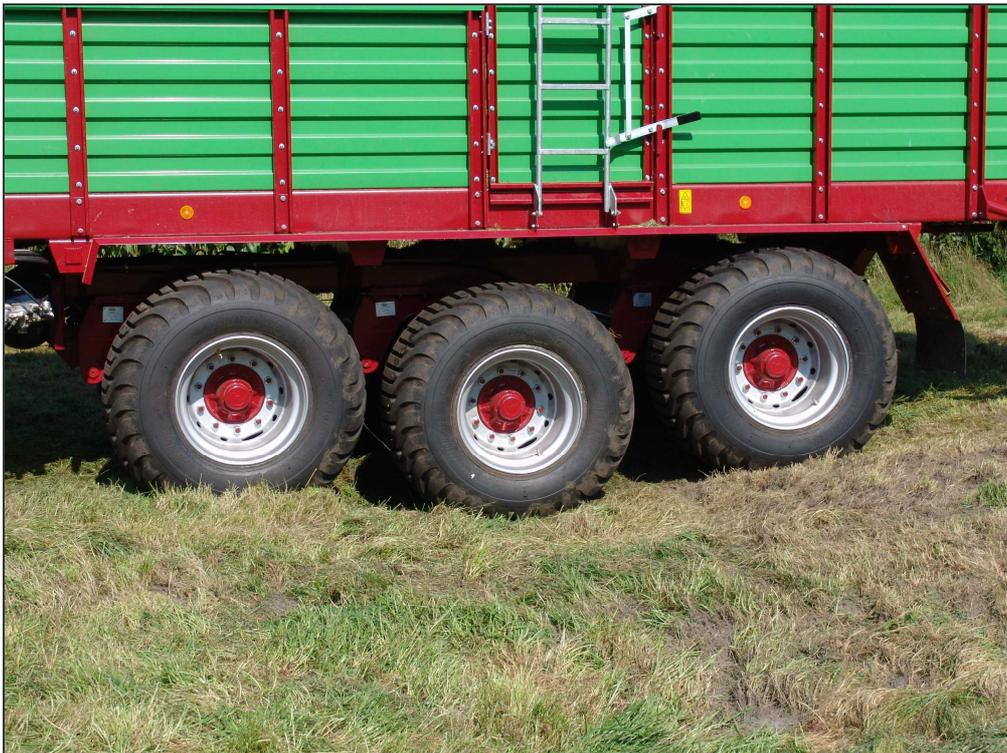
**Abbildung 11-1:** Giga Vitesse mit „GKN-FAD-Sidra-Tridemfahrwerk“ (Strautmann)
