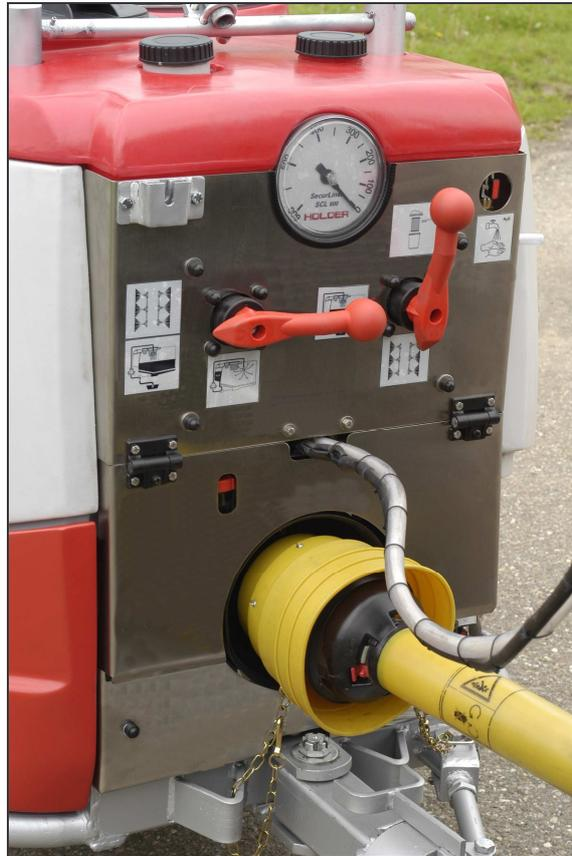
**Abbildung 10-2:**Holder zeigt eine Spritze mit geschlossener Bauweise von Armatur, Brühverteilung, Befüllung, Ventil und Filtereinheiten
