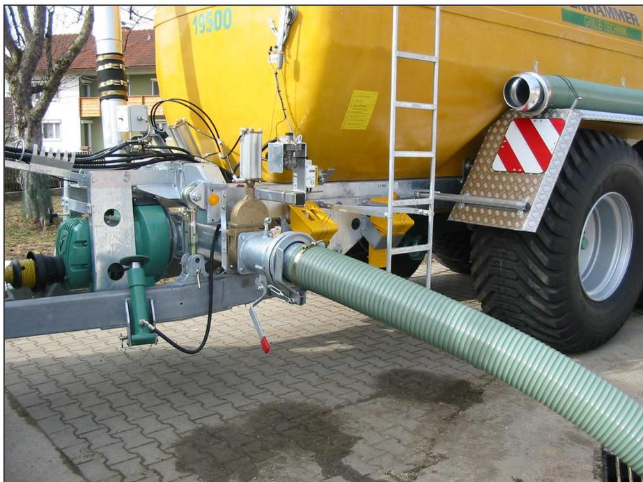
**Abbildung 8-1:** Vakumat Güllebefüllung mit Vakuum und Kreiselpumpe (Zunhammer)
