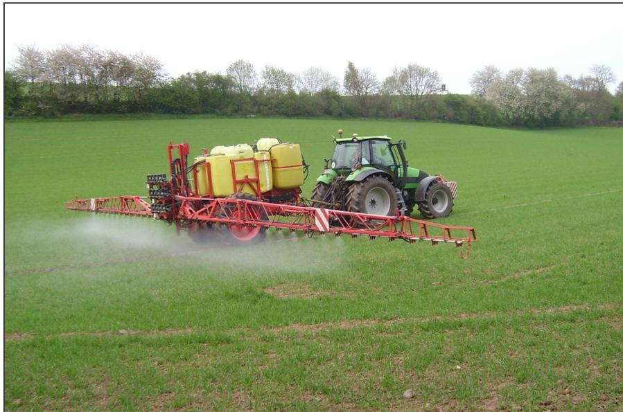
**Abbildung 10-3:** Diese Spritze von Rau erkennt Unkräuter und bringt bis zu drei verschiedene Pflanzenschutzmittel gezielt aus
